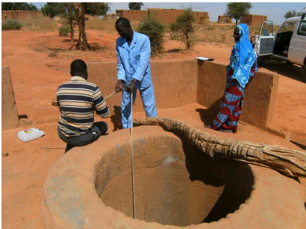
Photo 4 : Prélèvement d'eau souterraine au point d'eau N°10.2 (village Goudel Gourou Siminti) avec un seau à corde
