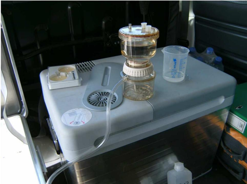
Photo 1 : Filtration d'eau avec un système de deux chambres, utilisant dépression
