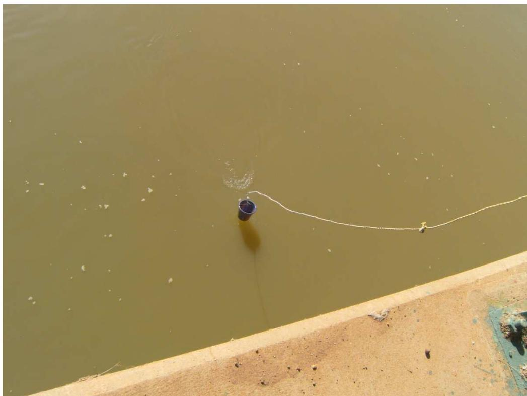
Photo 3 : Prélèvement d'eau de surface (fleuve Niger) avec un seau à corde du Pont Kennedy
