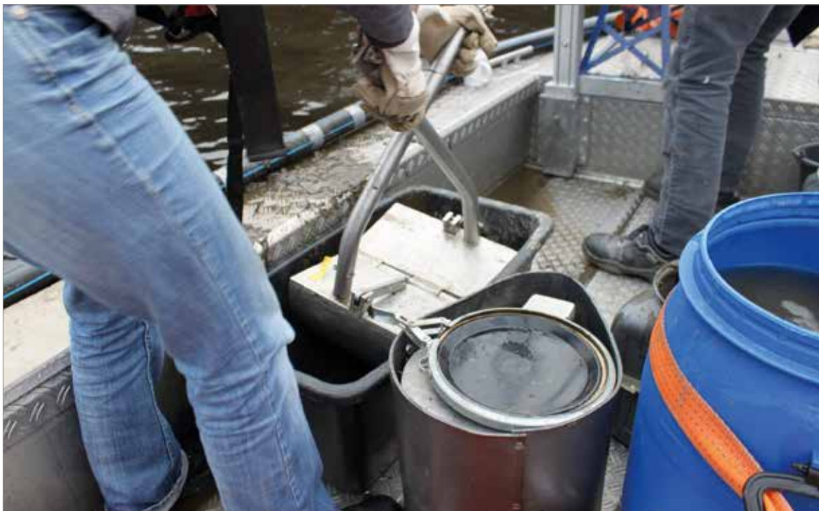
Abb. 4: Erstellung von Mischproben mithilfe eines Van-Veen-Greifers (IWW der RWTH Aachen University)
