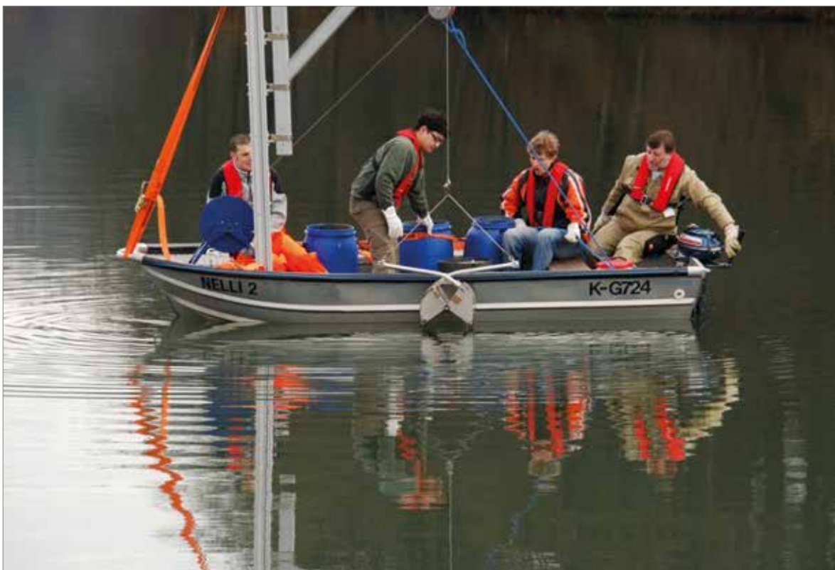
Abb. 6: Beprobung mithilfe eines Bootes und eines Van-Veen-Greifers (IWW der RWTH Aachen University)
