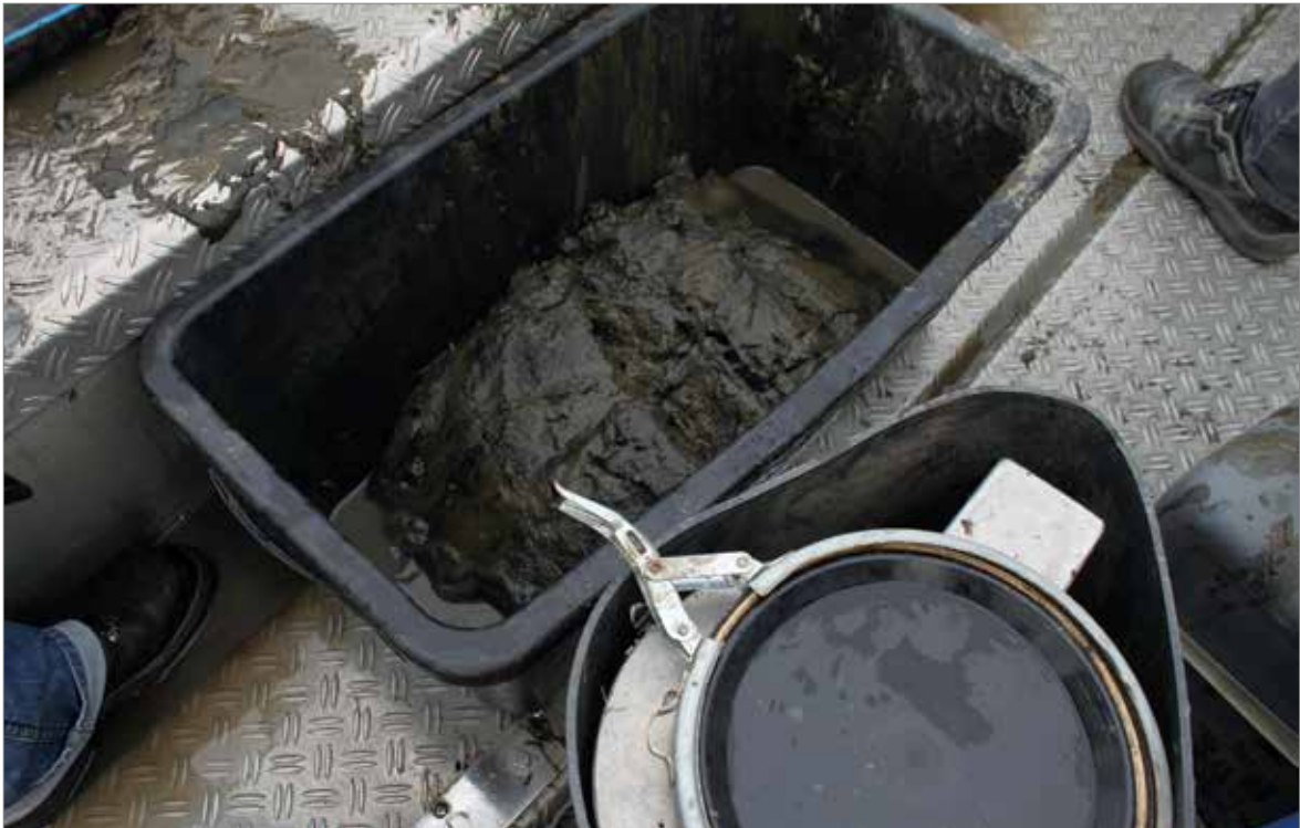
Abb. 5: Teilprobe – geborgen mithilfe eines Van-Veen-Greifers Mehrere dieser Proben wurden anschließend zu einer Mischprobe zusammengefasst (IWW der RWTH Aachen University)
