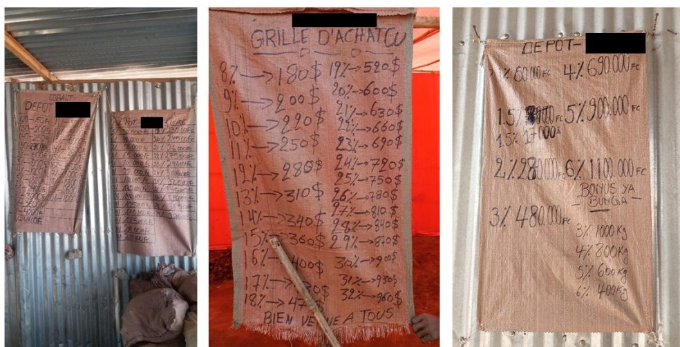
Abbildung 18. Preislisten für den Ankauf von Kupfer- und Kobalterzen, die einsehbar an Handelsdepots aushängen. Die Preise werden durch den Metallgehalt bestimmt, manche Depots zahlen Boni für höhere Tonnagen oder eine erhöhten Metallgehalt aus (rechts). Einige Depots nehmen die Erze von überall her an (Mitte)
