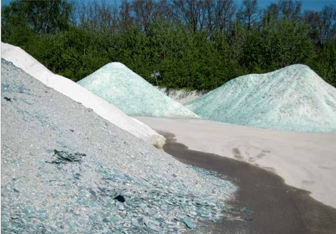
Abb. 32: Sortenreiner Glasbruch bei einem deutschen Recyclingunternehmen (v. l. Spiegelglas, h. l. und h. r. Lithium-haltiger Glasbruch (Quelle: BGR 2017)).
