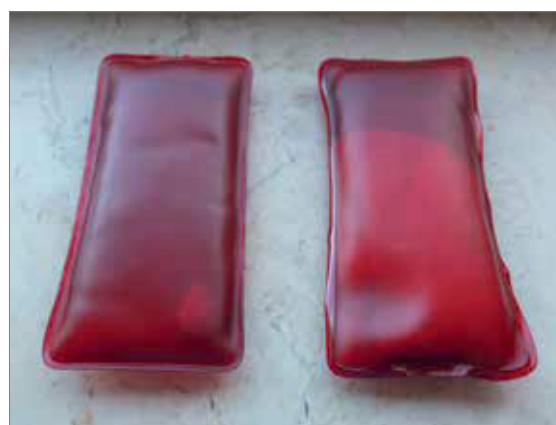
Abb. 4.71: Latentwärmespeicher für Handwärmekissen, links: vollständig flüssig, rechts: Kristallisation unter Wärmeabgabe (Quelle: FRAUNHOFER ISI)
