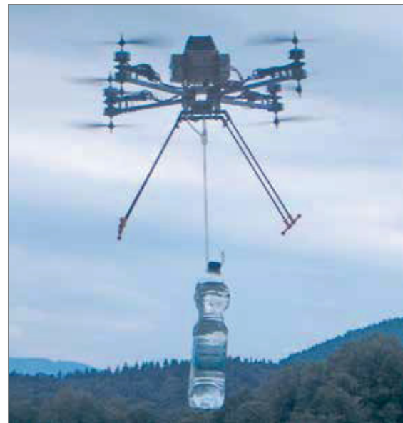
Abb. 4.19: Ein Oktocopter transportiert eine 1,5 Liter Getränkeflasche (Quelle: HCl2, WIKIMEDIA, CC BY-SA 3.0)
