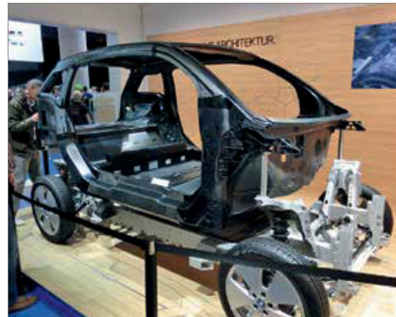
Abb. 4.114: Monocoque (Fahrgastzelle) des BMW i3 aus CFK auf Aluminium Fahrgestell (Quelle: Alexauto321, WIKIMEDIA)
