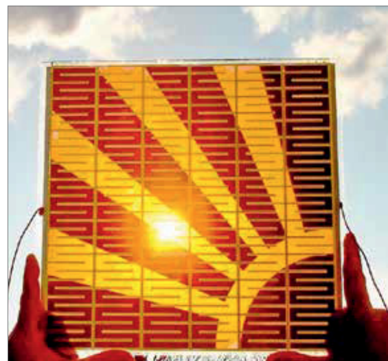
Abb. 4.46 Prototyp einer Farbstoffsolarzellen (Quelle: Fraunhofer ISE)
