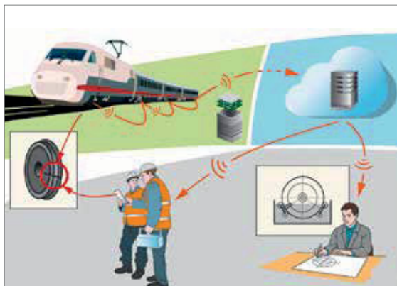
Abb. 4.78: Integration von autarker Sensorik für die Zustandsüberwachung von Transportmitteln (Quelle: NIEDERMAYER et al. 2014)
