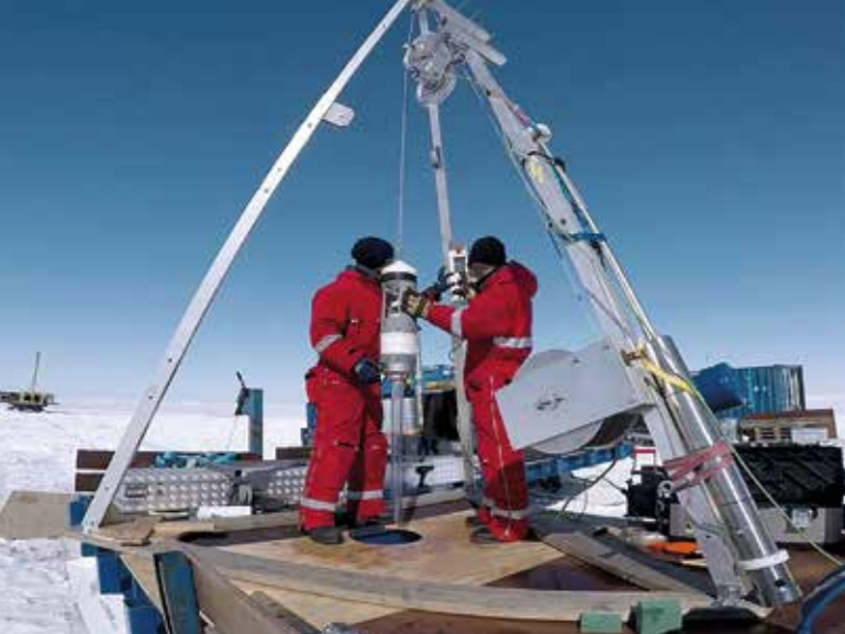
Probenahme mit Schwerelot während der Expedition Sub-EIS-Obs II auf dem Ekström Schelfeis.
