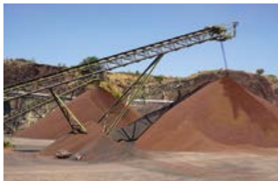
Am Anfang jeglicher Verwendung von Lavaschlacke steht die Klassierung des gebrochenen Rohsteins, hier im Steinbruch Plaidt der VELAG Vereinigte Lavawerke GmbH & Co. KG, Foto: BGR.
