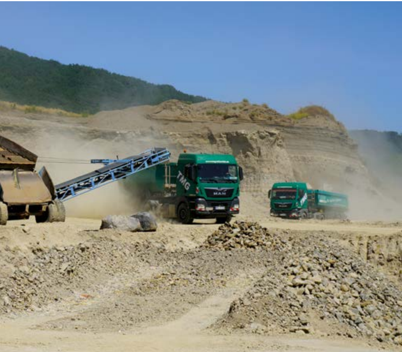
In der Bimsgrube „Meer“ der Gebr. Zieglowski GmbH & Co. KG stören die zahlreichen Blöcke aus der „Hauptbombenschicht“ und müssen vor Nutzung der restlichen Ablagerungen ausgesiebt werden, Foto: BGR.
