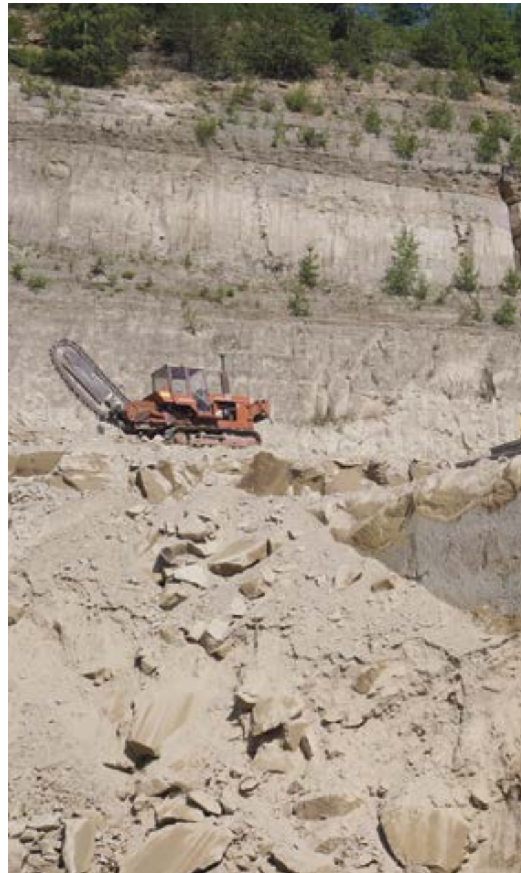
Im Weiberner Tuffsteinbruch „Am alten Berg“ der Mendiger Basalt Schmitz Naturstein GmbH & Co. KG stehen verschiedene Schrämmkettensägen zur Heraussägung von großen Rohsteinblöcken aus dem relativ weichen Gestein zur Verfügung, Foto: BGR.
