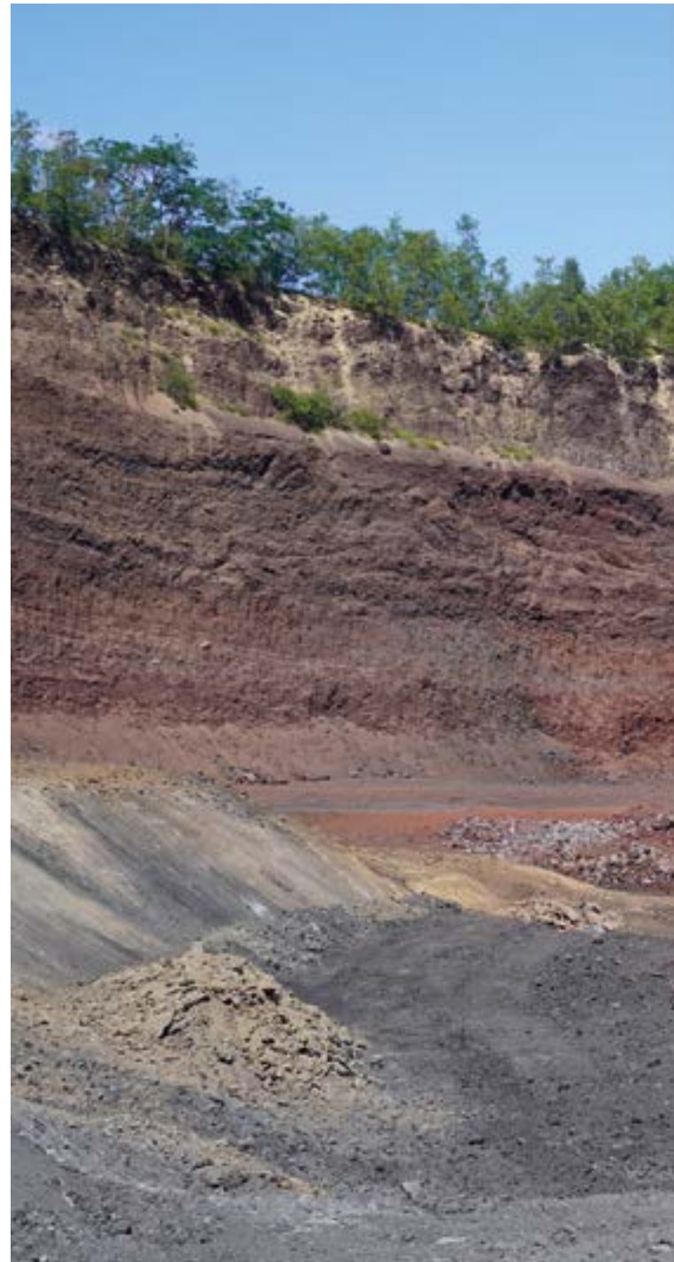
Gewinnung von besonders hochwertiger poröser und rötlicher Lavaschlacke im Steinbruch Nickenicher Weinberg durch die Trasswerke Meurin, Foto: BGR.
