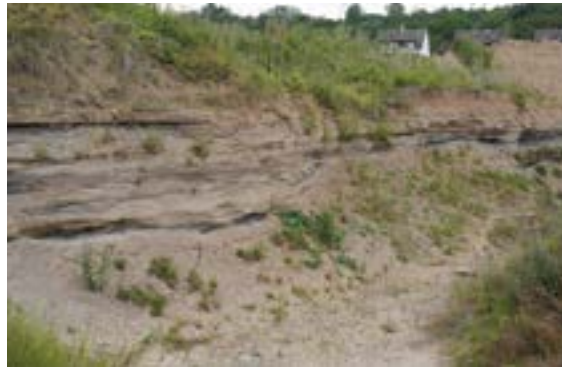
Blick in die Bimsgrube Kettig der Rünz & Hoffend GmbH & Co. KG direkt am Ortsrand der gleichnamigen Ortsgemeinde, wo unreiner, während einer Aufstauung des Rheins abgelagerter, ca. 4 m mächtiger Rohbims abgebaut wird, Foto: BGR.
