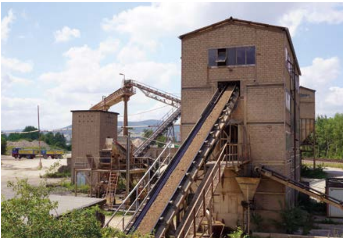
Die Bimswaschanlage der AG für Steinindustrie am Standort Plaidt wird über ein Förderband mit Rohbims versorgt, Foto: BGR.
