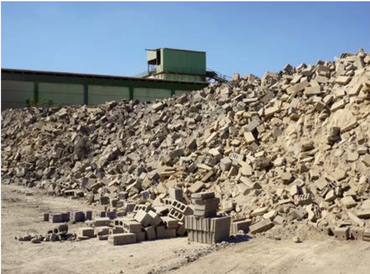
Bimsbausteine können vollständig recycelt werden. Hier Produktionsausschuss im Werk Plaidd der Trasswerke Meurin, der auf unter 16 mm Korngröße gebrochen und dann in den Produktionsprozess zurückgeführt wird, Foto: BGR.
