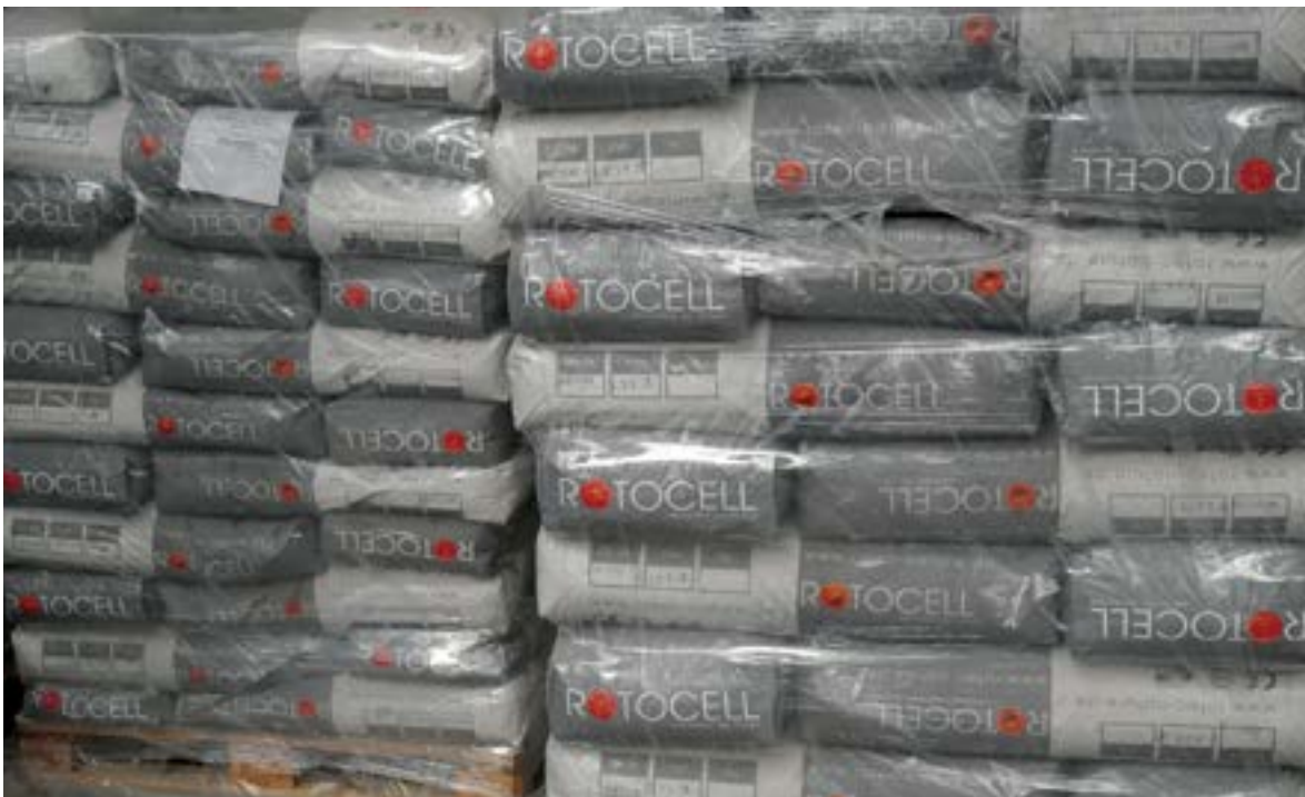
ROTOCELL® ist der Markenname für aufgemahlenes Bimsgranulat (0,04 – 4 mm) der ROTEC® GmbH & Co. KG, das in der Baustoffindustrie vielfältigen Einsatz findet, Foto: BGR.
