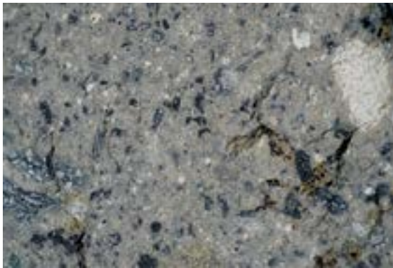
Dieser typische Suevit aus dem Steinbruch Aufhausen Mitte-West der SCHWENK Zement KG zeigt in feinkörniger Grundmasse aus zerriebenen Sedimentgesteinen dunkelgraue Gläser, teils in „Flädle“-Form, sowie hellgraue Einschlüsse eines stark verwitterten Granits, Foto: BGR.
