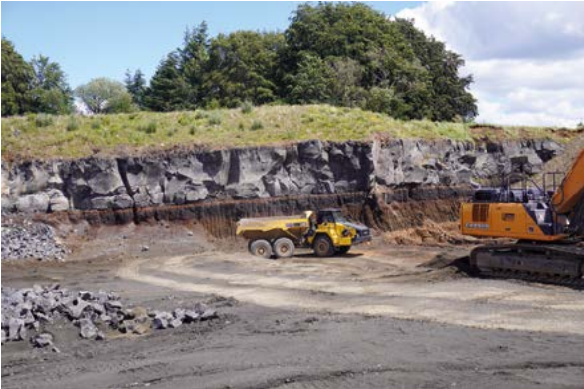
Im zentralen Teil des Steinbruch Dockweiler der Backes Bau- und Transporte GmbH wird unter anderem Basaltlava (grau) über schwarzen Schweißschlacken und brauner, verschweißter Tephra des Schlackenvulkans In-der-Eyd-Ost abgebaut, Foto: BGR.
