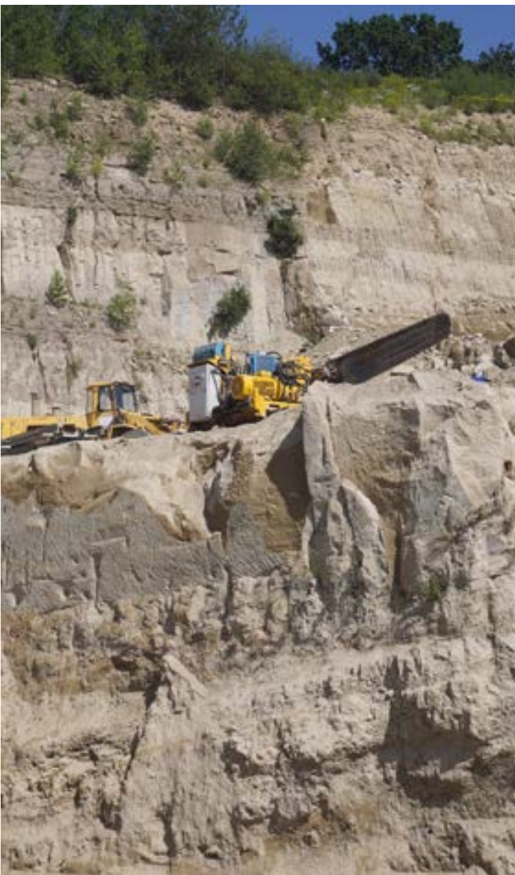
Auch im Ettringer Tuffsteinbruch der Mendiger Basalt Schmitz Naturstein GmbH & Co. KG ist die Gewinnungsweise mittels langschwertiger Schrämmkettensägen gut erkennbar, Foto: BGR.
