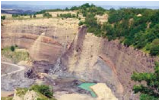
Blick in den Steinbruch Ochtendung der AG für Steinindustrie. Hier stehen mächtige Lavaschlacken (rötlich) unter bedeckendem Löß (ockerfarben) in Abbau. Rechts im Bild ist ein Basaltgang zu erkennen, Foto. BGR.
