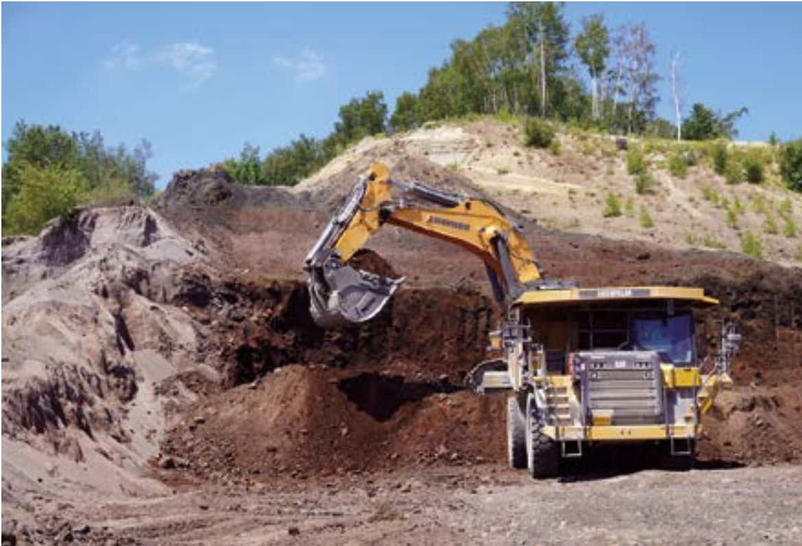
Direkt unterhalb der Tephraschichten des Laacher-See-Vulkans (hell) werden seit kurzem im Steinbruch Nickenich der RPBL wieder Lavaschlacken (rotbraun) abgebaut, vor allem auch, um Platz für eine Erweiterung des tiefen Basaltsteinbruchs zu schaffen, Foto: BGR.
