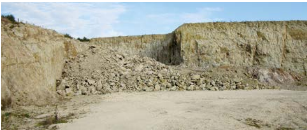
Blick in den aktiv genutzten Teil des Suevitsteinbruchs Aumühle bei Hainsfurth. Hier wird der Suevit mehrmals jährlich durch Sprengungen gewonnen. In der Bildmitte rechts ist die unter dem Suevit lagernde „Bunte Brekzie“ erkennbar, Foto: Märker Zement GmbH (mit frdl. Genehmigung).
