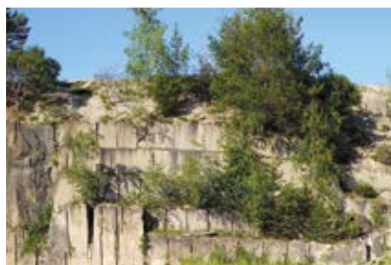
Auch im Ettringer Tuffsteinbruch der Mendiger Basalt Schmitz Naturstein GmbH & Co. KG ist die Gewinnungsweise mittels langschwertiger Schrämmkettensägen gut erkennbar, Foto: BGR.
