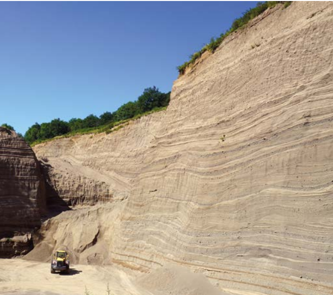
In der vor wenigen Jahren neu eröffneten Bims-Lavasandgrube Wingertsbergwand der AG für Steinindustrie stehen neben Bimslagen der mittleren Eruptionsphase vor allem mächtige Asche-Lavasand-Schichten der jüngsten Eruptionsphase des Laacher-See-Vulkans im Abbau, Foto: BGR.
