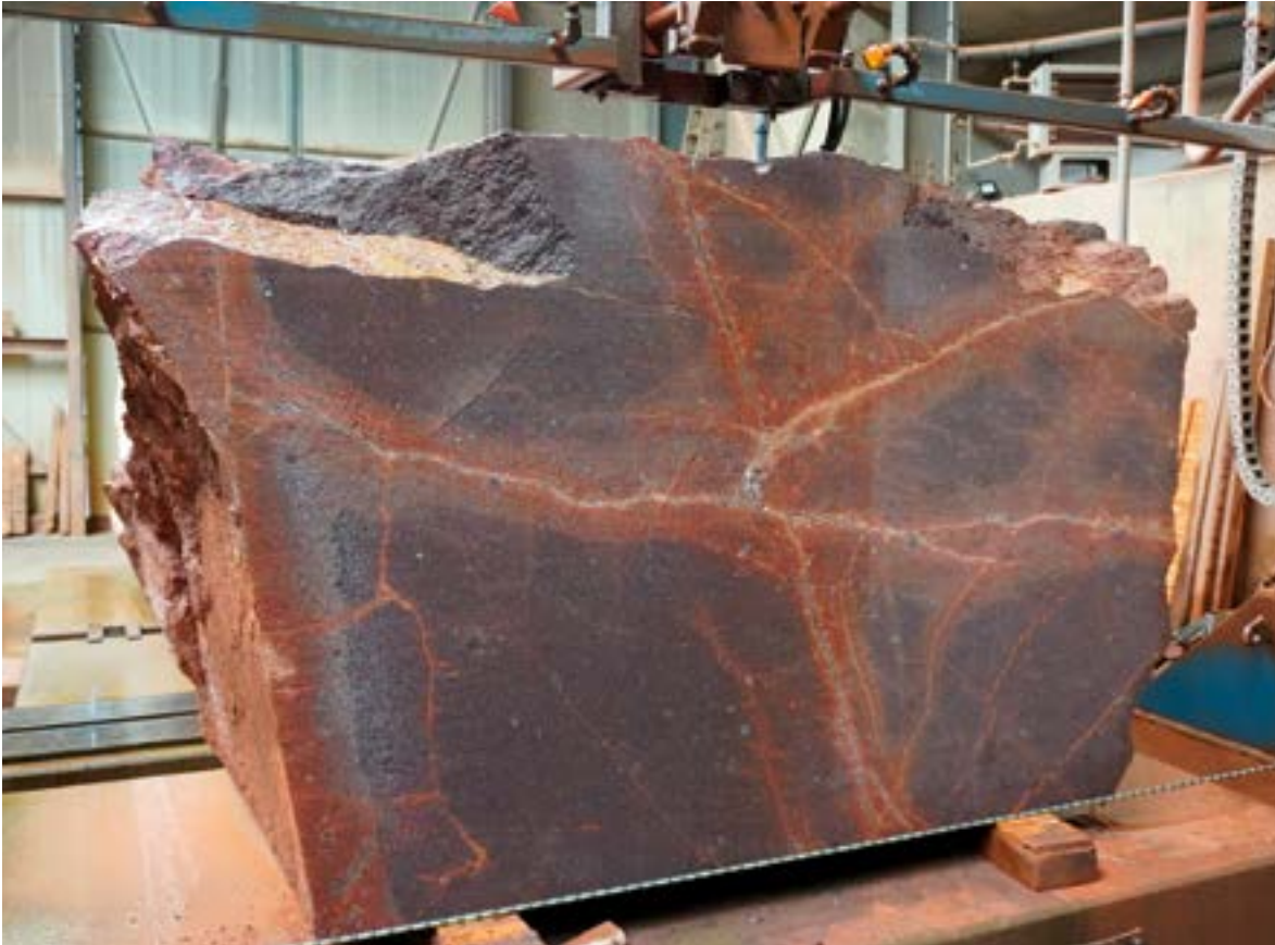
Ein großer Block aus frischem Rochlitzer Porphyrtuff wartet im Werk der Vereinigte Porphyrbüche auf dem Rochlitzer Berge GmbH auf seine Bearbeitung, Foto: BGR.
