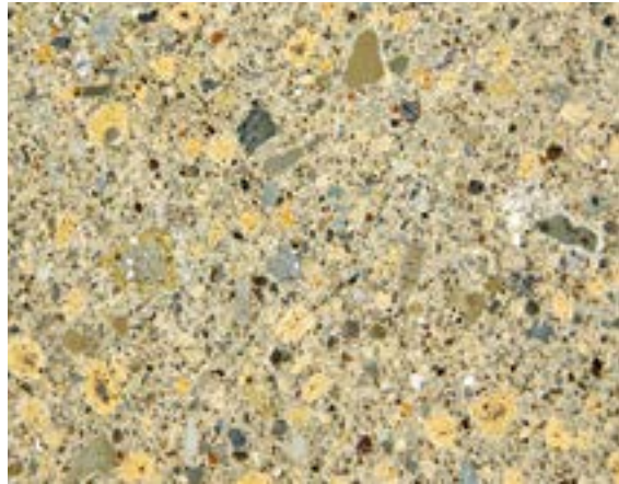
Detailfoto von typischem Ettringer Tuffstein, Foto: BGR.
