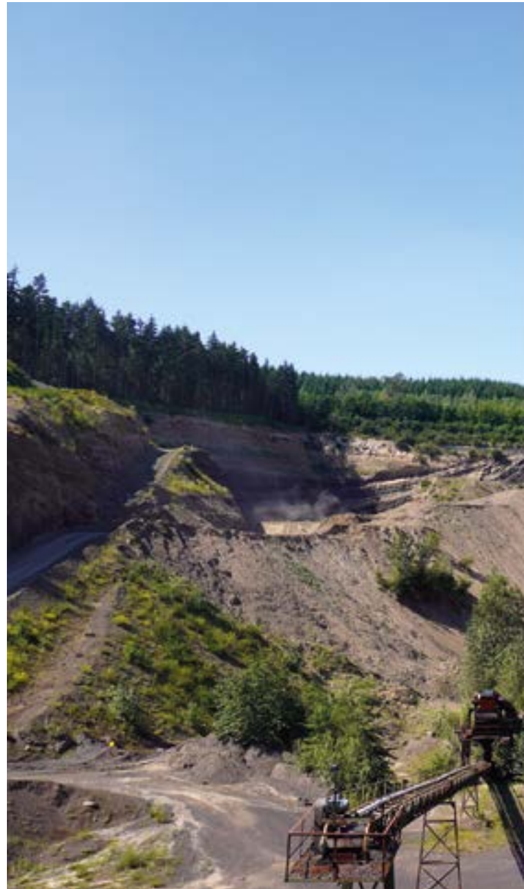
Blick in den Steinbruch Ochtendung der AG für Steinindustrie. Hier stehen mächtige Lavaschlacken (rötlich) unter bedeckendem Löß (ockerfarben) in Abbau. Rechts im Bild ist ein Basaltgang zu erkennen, Foto. BGR.
