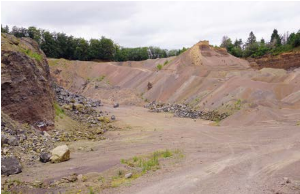
Große Vorratshalden gebrochener, hochwertiger Lavaschlacke im Steinbruch Hohenfels-Essingen der Eifel-Lava-Hohenfels GmbH & Co. KG, Foto: BGR.
