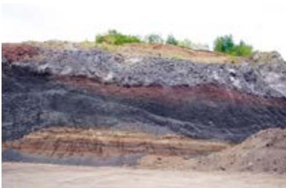
Östliche Abbaumwand im Süden der Lavasandgrube Betteldorf mit von unten nach oben: sehr gut geschichtete feinkörnige Aschentuffe (braun) – mit Bomben und Schlacken durchsetzte Lapillitephra (schwarz/rotbraun) – Basaltlava (grau) – Löß und Aschen (Abraum), Foto: BGR.
