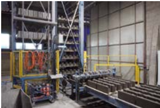
Produktion von Leichtbetonbausteinen im Werk Kruft der Gebr. Zieglowski GmbH & Co. KG, Foto: BGR.
