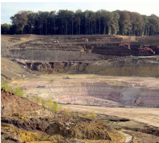
Der Tontagebau „Meudt“ ist einer der größten im Westerwald und liefert neben keramischen Tonen auch Tone für Ringraumabdichtungen im Brunnenbau, Foto: BGR.
