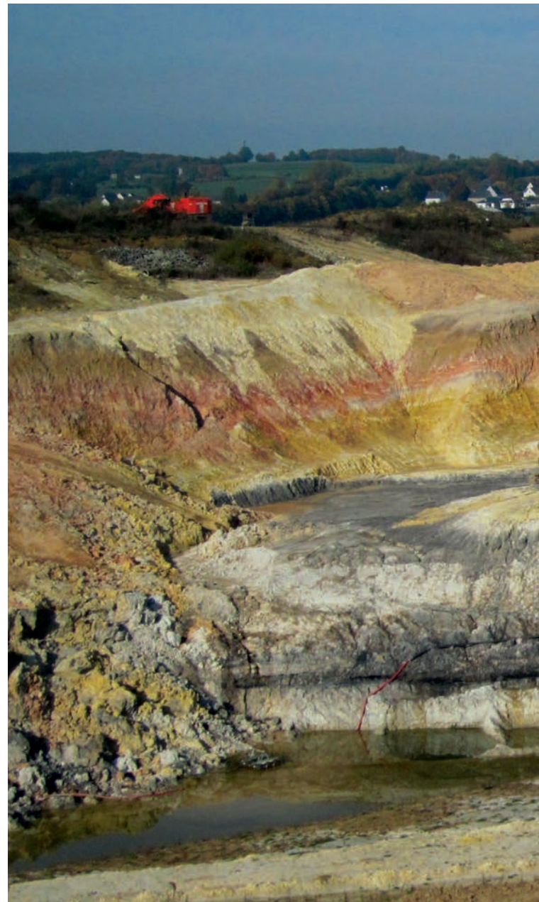
Im Tontagebau „Sedan“ ist eine umfangreiche Abfolge von bunten kaolinitischen Tonen und Braunkohlenflözen aufgeschlossen. Der sehr hochwertige dunkelgraue Bleistiftton (Bildmitte) wurde in einem kleinen See abgelagert und ist einmalig im Westerwald, so dass es sich lohnt, ihn besonders sorgfältig freizulegen und abzubauen, Foto: BGR.
