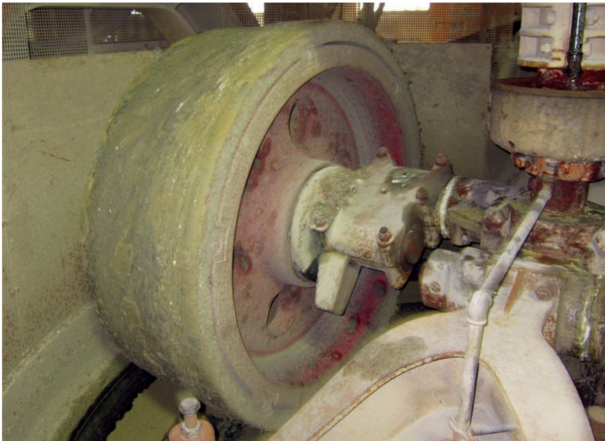
Im Werk Moosburg der Clariant Produkte (Deutschland) GmbH wird Rohbentonit in einem sogenannten Kollergang fein zermahlen, Foto: BGR.
