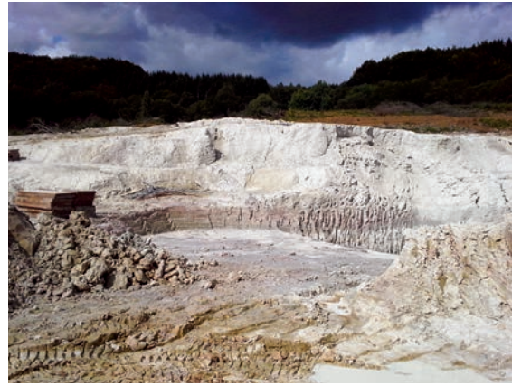
Blick in die Tongrube „Hermann“, in der vor allem hochqualitative Töne für die keramische und die Feuerfestindustrie gewonnen werden, Foto: Sibelco Deutschland GmbH (mit frdl. Genehmigung).
