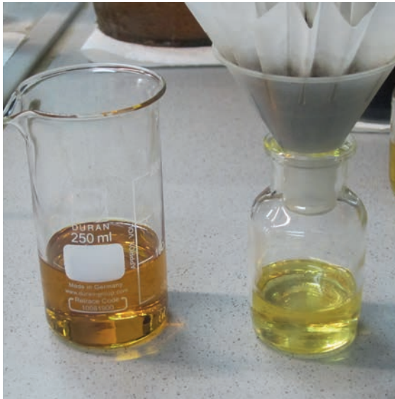
Im Werk Moosburg der Clariant Produkte (Deutschland) GmbH werden Palm- und Olivenöle aus aller Welt getestet, ob sie mit bayerischem Bentonit bzw. Bleicherde entfärbt werden können, Foto: BGR.
