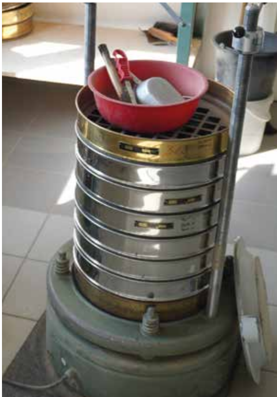
Definierte Korngrößenverteilungen, meist ermittelt durch Siebanalysen, sind Bestandteil jeder Norm jeder Gesteinskörnung in Europa, Foto: BGR.
