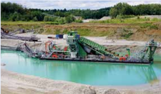
Sehr modern, sehr effektiv und sehr teuer. Ein neuer schwimmender Eimerkettenbagger kostet über 3 Mio. €, Foto: BGR.
