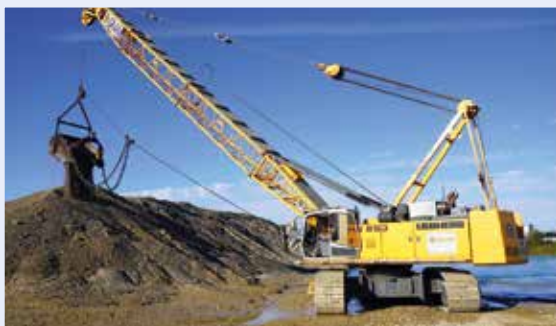
Seilkübelbagger sind in vielen Kieswerken in Süddeutschland im Einsatz, wo sie zur Gewinnung der grobkörnigen Kiessande gut geeignet sind. Will man einen solchen Bagger nicht mieten, sondern selber kaufen, muss man mit Investitionskosten von bis zu 1,3 Mio. € rechnen, Foto: BGR.
