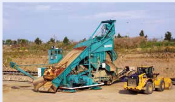
Durch Weiterentwicklungen zu vollelektrisch angetriebenen Geräten, einschließlich den Fahrwerken, sind auch heute moderne Schrapper im Einsatz, Foto: BGR.
