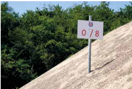
In den meisten Kieswerken sind alle Sorten klar gekennzeichnet, hier eine Halde mit natürlichem Korngemisch 0 – 8 mm Durchmesser, abgekürzt „0/8“, Foto: BGR.
