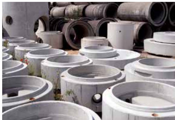
Abwasserrohre und -schächte gehören zu den Betonfertigteilen und können schon allein aus Umweltschutzgründen nicht aus alternativen Baustoffen, wie Holz oder Lehm, hergestellt werden, Foto: BGR.
