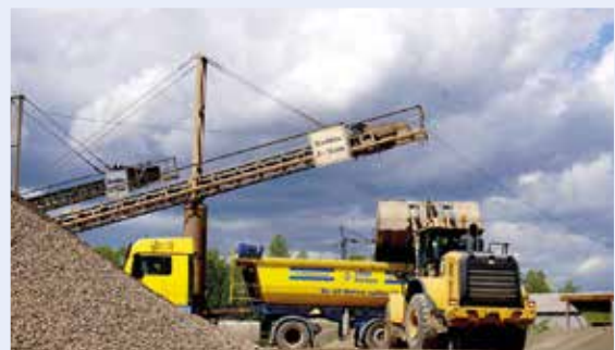
Die Verladung der Lieferkörnungen auf Lkws erfolgt automatisch (über Bandwaagen) oder mittels Radlader (durch Radladerverwiegung oder über Fahrzeugwaagen), Foto: BGR.
