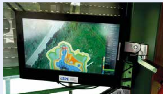
Bildschirm einer automatischen Abbaukontrollanlage. Mit derartigen Anlagen wird die Position des Baggers und des Lösewerkzeugs cm-genau bestimmt, alle Informationen direkt visualisiert und alle Daten auch ständig aufgezeichnet. Auf diese Daten können später auch die Genehmigungsbehörden zur Überwachung der genehmigungsrechtlichen Auflagen zugreifen, Foto: BGR.
