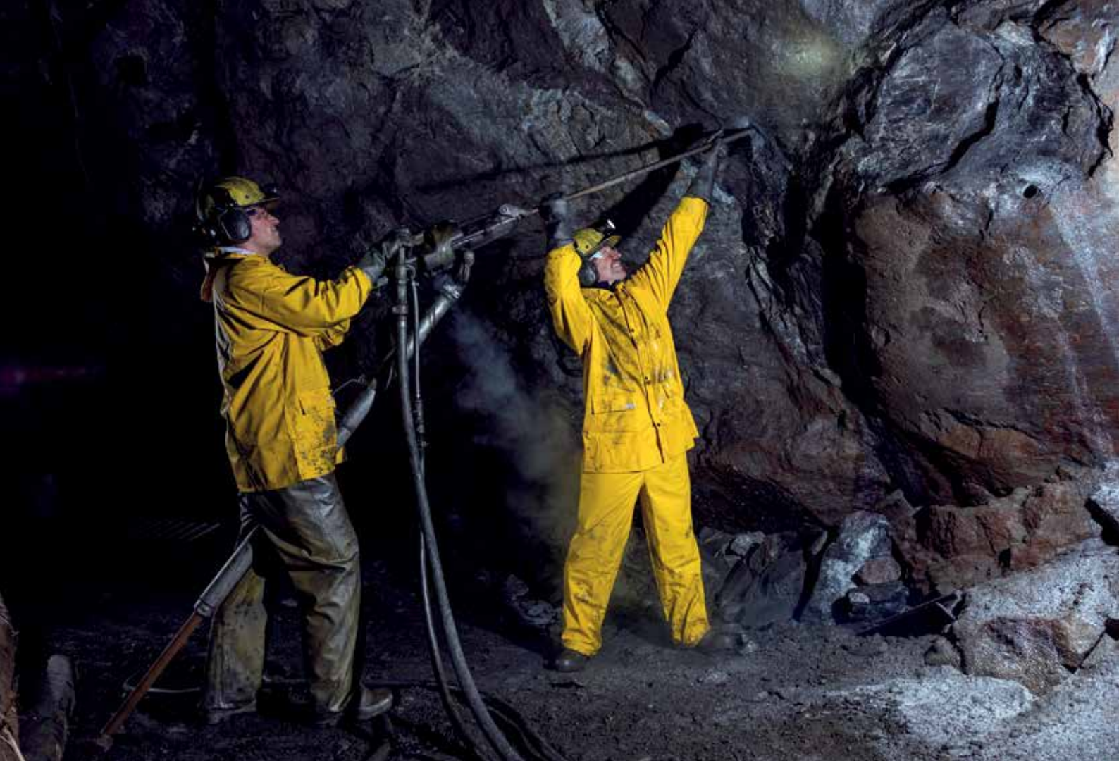
Die untertägige Gewinnung im Graphitbergwerk Kropfmühl erfolgt mittels Bohren und Sprengen in der Regel durch zwei am gleichen Ort arbeitende Bergleute, Foto: Graphit Kropfmühl GmbH (mit frdl. Genehmigung).
