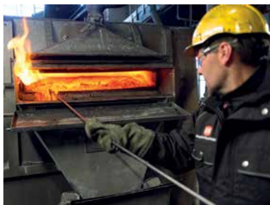
Thermische Reinigung von Graphit im Graphitwerk Kropfmühl in Bayern, Foto: Graphit Kropfmühl GmbH (mit frdl. Genehmigung).
