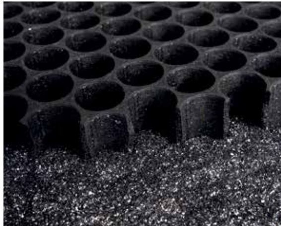
Expandiertem Polystyrol wird Graphit zur Erhöhung der Wärmedämmeigenschaften zugegeben, Foto: Graphit Kropfmühl GmbH (mit frdl. Genehmigung).
