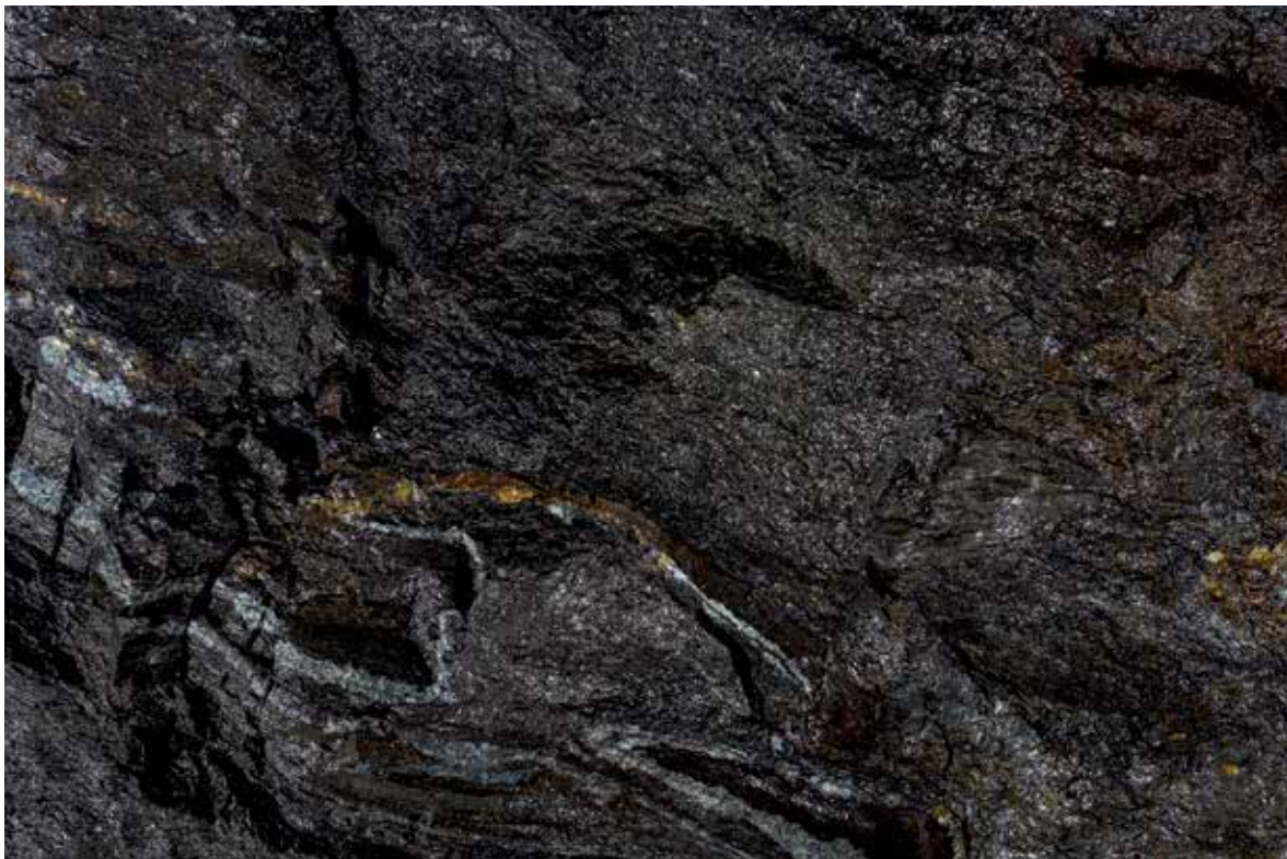
Das Graphiterz aus Kropfmühl enthält durchschnittlich 25% Kohlenstoff, Foto: Graphit Kropfmühl GmbH (mit frdl. Genehmigung).
