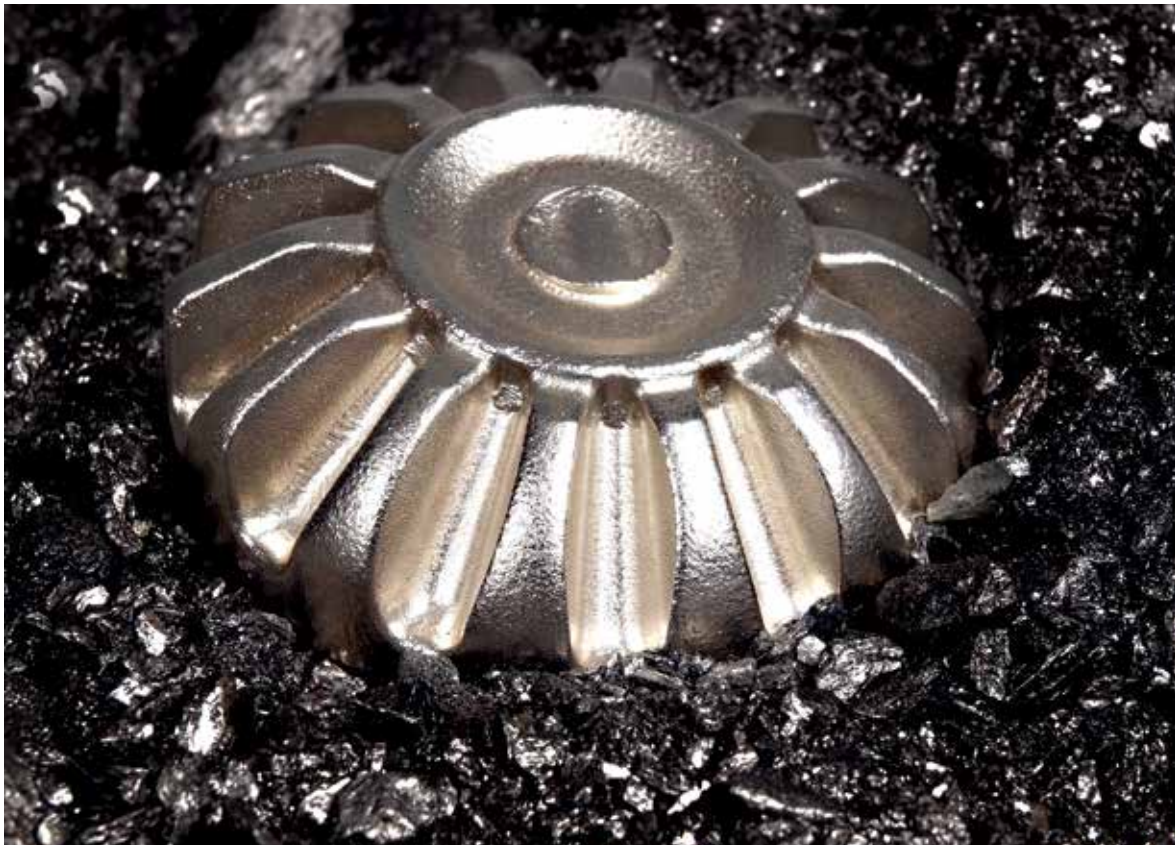
Schmiedeteile werden in der Metallumformtechnik häufig mit Graphit geschmiert, Foto: Graphit Kropfmühl GmbH (mit frdl. Genehmigung).
