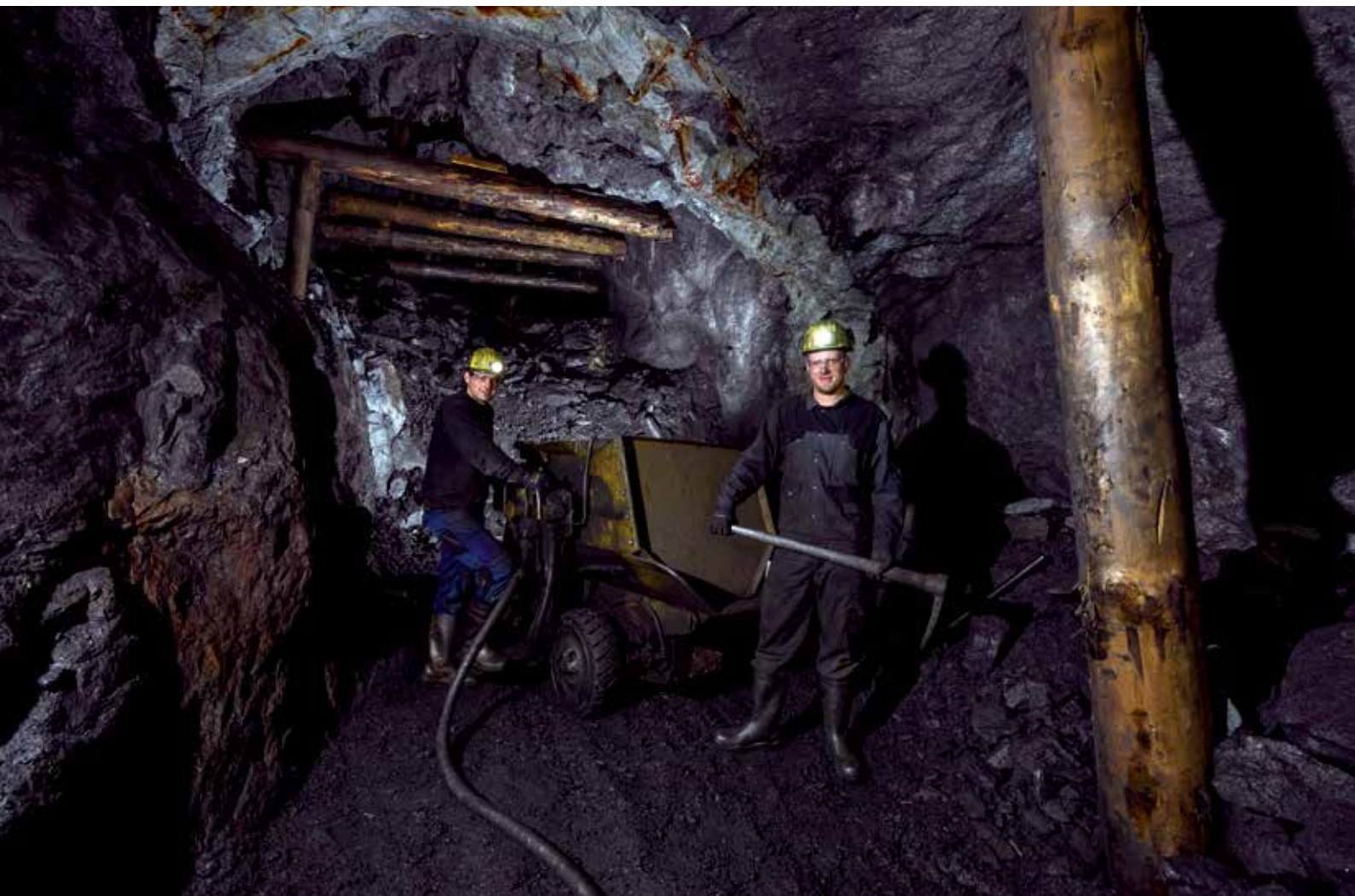
Die untertägige Gewinnung im Graphitbergwerk Kropfmühl erfolgt mittels Bohren und Sprengen in der Regel durch zwei am gleichen Ort arbeitende Bergleute, Foto: Graphit Kropfmühl GmbH (mit frdl. Genehmigung).
