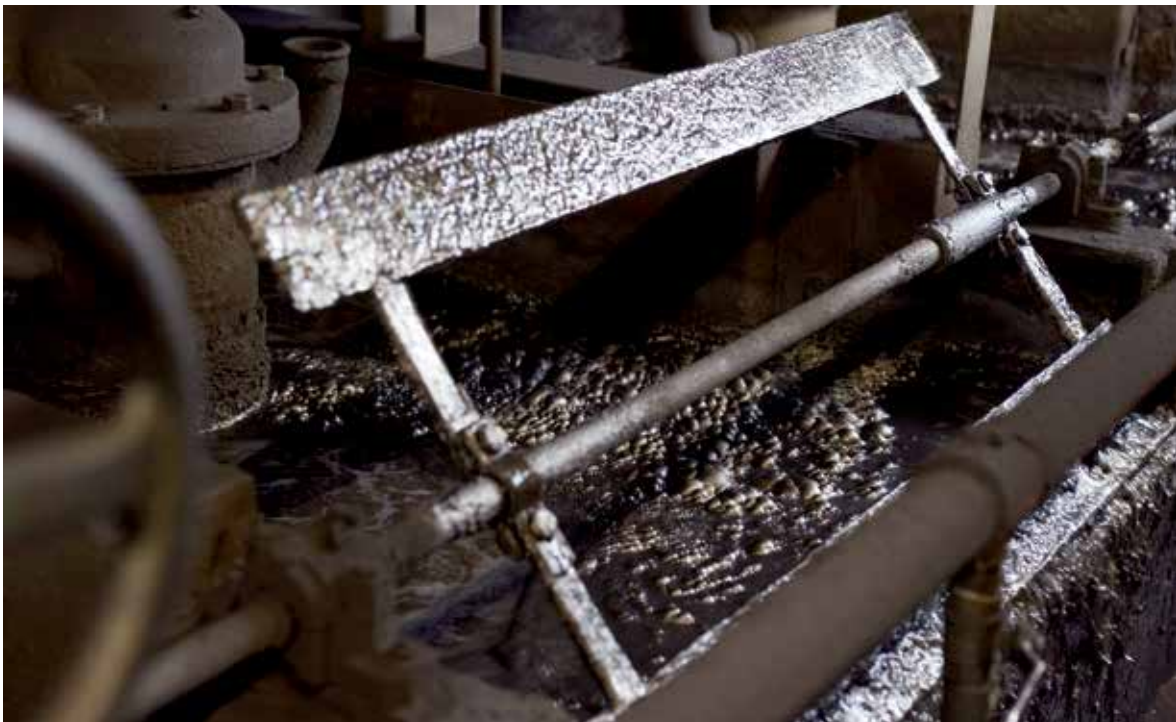
Flotation von Graphitkonzentrat im Graphitwerk Kropfmühl in Bayern, Foto: Graphit Kropfmühl GmbH (mit frdl. Genehmigung).
