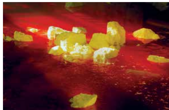
Die Schwefelpfannen werden immer wieder neu mit flüssigem Schwefel aus der Claus-Anlage befüllt, dabei schwimmen die Reste von älterem Brocken-schwefel auf, Foto: Solvay Infra Bad Hönningen GmbH (mit frdl. Genehmigung).
