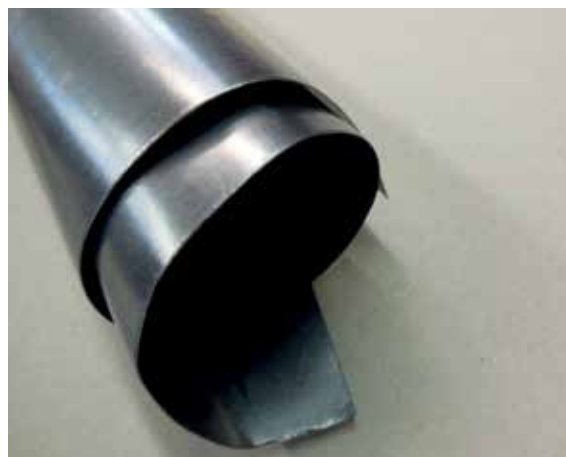
Folien aus Blähgraphit dienen vor allem der Wärmeableitung in Autos, elektronischen Bauteilen sowie Batterien, Foto: Graphit Kropfmühl GmbH (mit frdl. Genehmigung).
