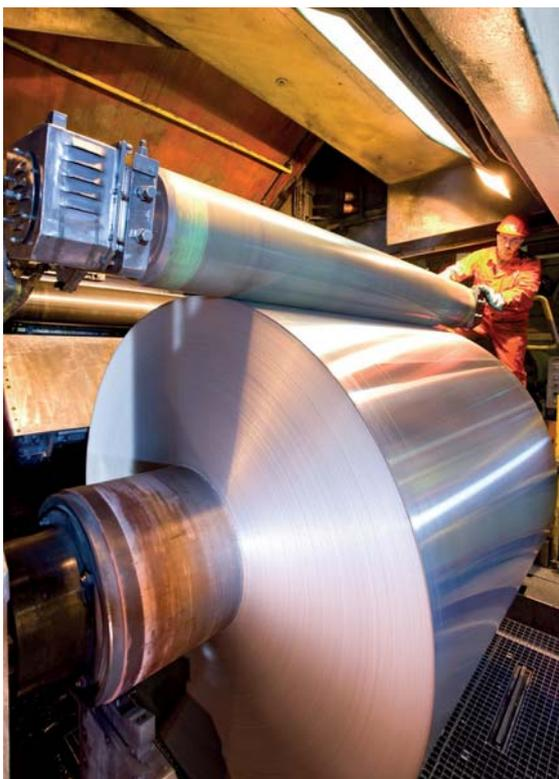
*Aus Rohaluminium werden neben Aluminiumformguss und Aluminiumhalbzeugen z. B. auch Aluminiumfolien gefertigt. In Walzwerken lässt sich Aluminium bis auf eine Folienstärke von 0,007 mm walzen und bleibt doch komplett undurchdringlich für Licht und Aromastoffe, Foto: Norsk Hydro ASA (mit frdl. Genehmigung).*
