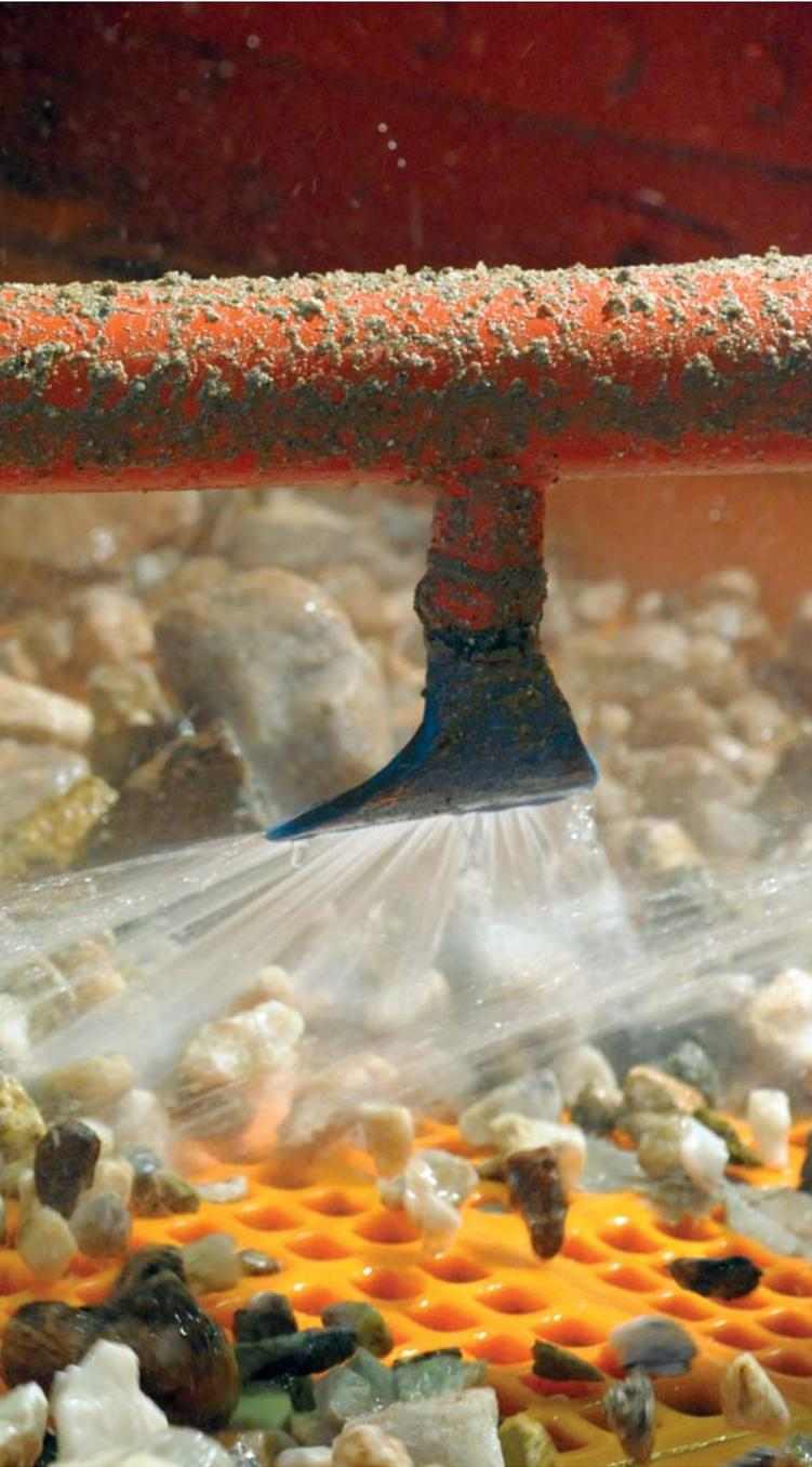
*Gewaschenes Roherz der Korngrößenfraktion > 16 mm auf dem oberen Siebdeck eines Schwing-siebtes. Hier sind noch alle Nebenbestandteile enthalten, Foto: Sachtleben Bergbau GmbH & Co. KG (mit frdl. Genehmigung).*
