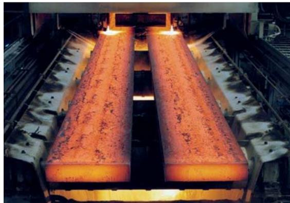
*Flussspathaltige Gießpulver sorgen in Stranggießanlagen von Stahlwerken für einen reibungslosen Betrieb in dem sie u. a. den Transport der teilverfestigten Stahlstränge entlang der Kokillenwände erleichtern, Foto: IMERYS Metalcasting Germany GmbH (mit frdl. Genehmigung).*
