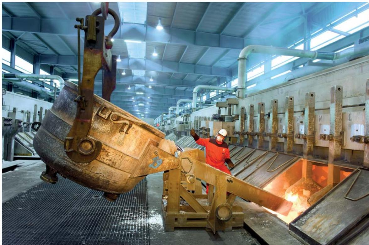
*Herstellung von Aluminium in der Primäraluminiumhütte Rheinwerk in Neuss. In diesem Werk werden unter Einsatz von Aluminium- und Calciumfluorid im Jahr rund 150.000 t Flüssigaluminium produziert. Foto: Norsk Hydro ASA (mit frdl. Genehmigung).*
