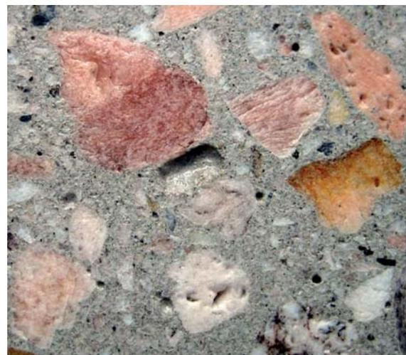
*Für den Einsatz von Betonspat in Schwer- oder Strahlenschutzbeton ist weniger dessen Farbe als vielmehr seine Korngrößenverteilung von Bedeutung, Foto: PONTAX GmbH (mit frdl. Genehmigung).*
