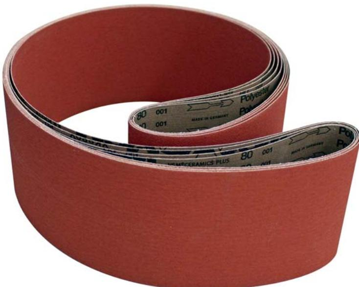
*In diesem Schleifband werden die enthaltenen Kermischleifkörner durch eine selbstschmierende und -kühlende schleifaktive Deckschicht geschützt („Top Size Schicht“). Beim Schleifen von Metall verhindern die in der „Top Size Schicht“ enthaltenen Fluoride das Zusetzen des Schleifmittels mit abgetragenen Metallspänen, Foto: VSM Vereinigte Schmirgel- und Maschinen-Fabriken AG (mit frdl. Genehmigung).*
