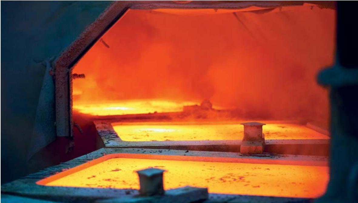
*Vor dem Anodengießen in der Kupferraffination wird Schwerspatpulver mit Wasser angerührt und auf die heißen Gießformen gesprüht, wobei das Wasser verdampft. Als Trennmittel erleichtert der Schwerspat nach dem Guss das Herauslösen der Kupferanoden, Foto: Detlef Overmann, Copyright Aurubis AG.*
