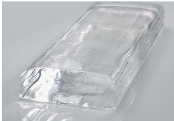
*Das Fluorphosphatglas N-FK58 XLD weist eine extrem niedrige Dispersion (Abhängigkeit der Lichtbrechung von der Wellenlänge) und sehr gute Bearbeitungseigenschaften auf und wird daher zur Farbkorrektur in optischen Systemen (z. B. in Objektiven für Spiegelreflexkameras) eingesetzt, Foto: Schott AG (mit frdl. Genehmigung).*
