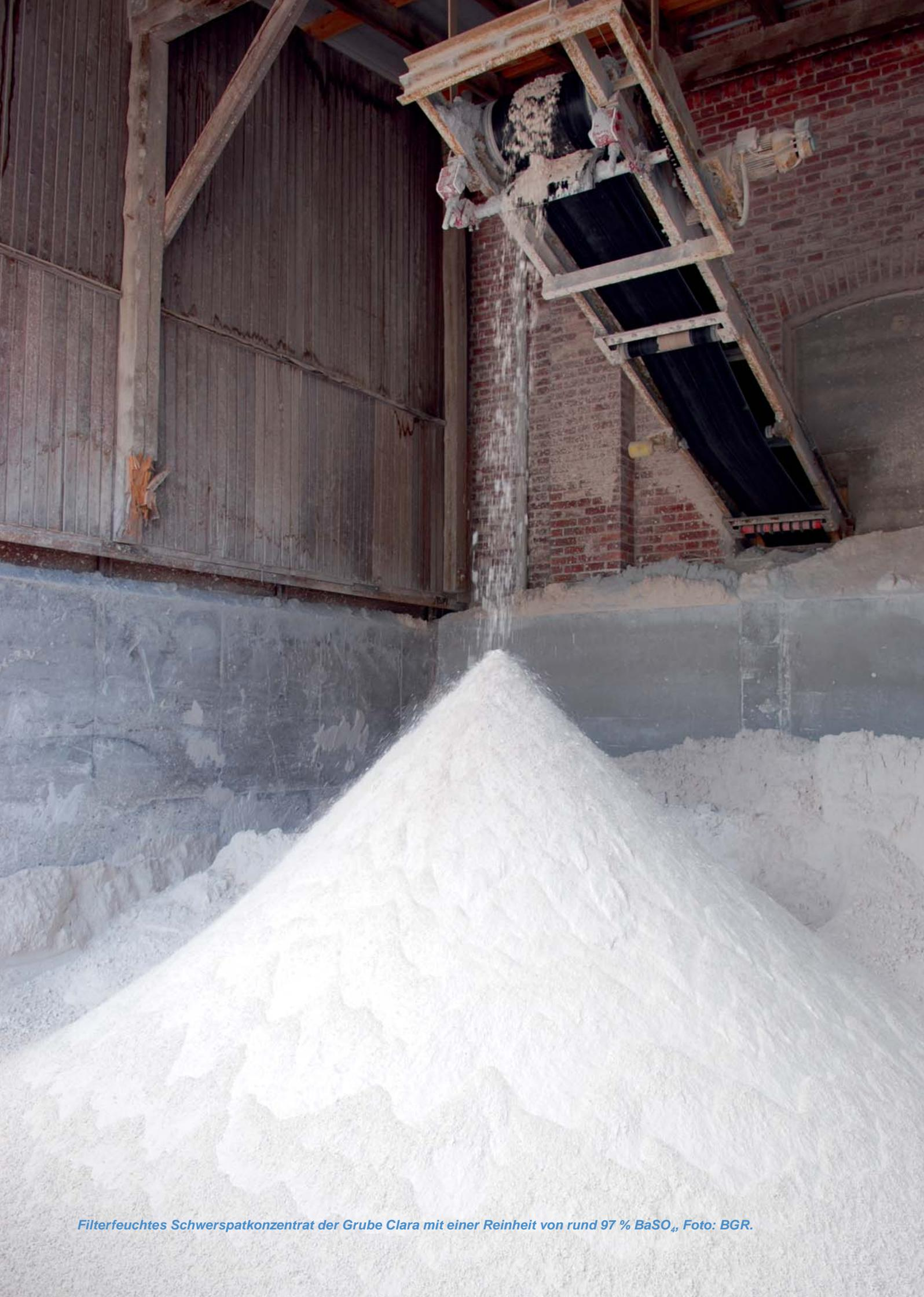
*Filterfeuchtes Schwerspatkonzentrat der Grube Clara mit einer Reinheit von rund 97 % BaSO<sub>4</sub>, Foto: BGR.*
