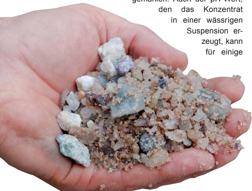
Flussspatvorkonzentrat nach der Dichtesortierung, Foto: BGR.
