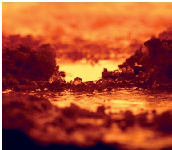
*Blick in eine Glasschmelzwanne, in der gerade Rohstoffe, darunter Bariumcarbonat, zur Herstellung von ultradünnem Glas eingeschmolzen werden, Foto: Schott AG (mit frdl. Genehmigung).*
