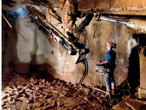
*Bohren der Sprengbohrlöcher mit einem elektrohydraulischen Bohrwagen, Foto: Sachtleben Bergbau GmbH & Co. KG (mit frdl. Genehmigung).*
