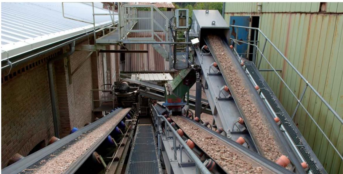
*Verschiedene Produktströme in der Aufbereitungsanlage der Grube Clara (rechts: vorgebrochenes Roherz, links: Vorkonzentrat nach der Dichtesortierung), Foto: Sachtleben Bergbau GmbH und Co. KG (mit frdl. Genehmigung).*
