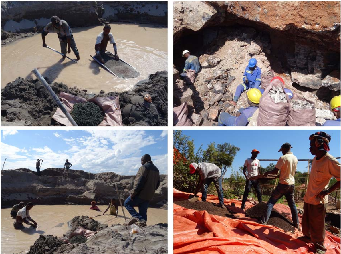
Abbildung 13 Aufbereitungsprozesse im kongolesischen Kleinbergbau auf Kupfer und Kobalt. Zu sehen sind Wasch- und Brechprozesse sowie das Sieben von bereits zuvor ausgewaschenen Erz-Vorkonzentraten.
