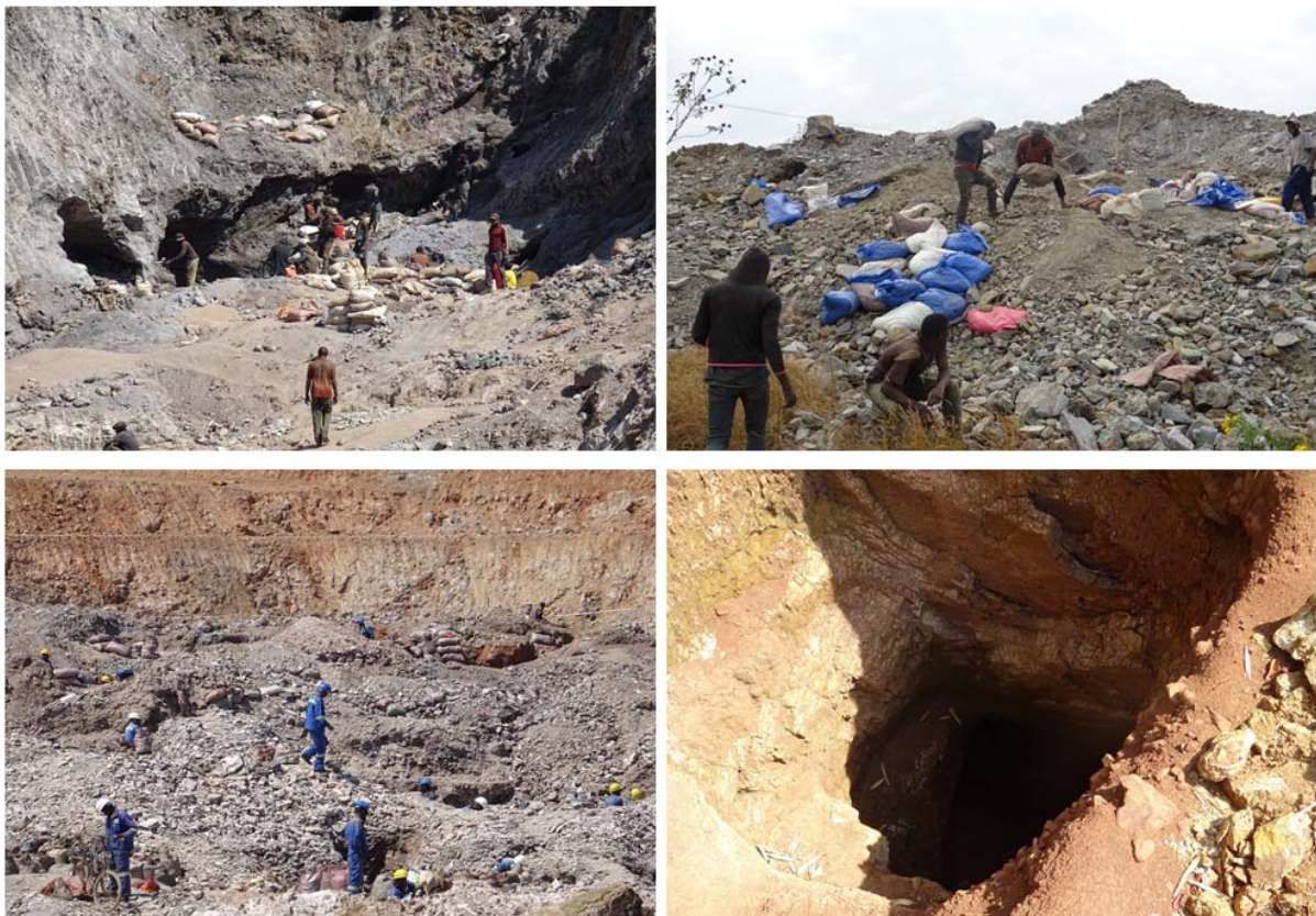
Abbildung 25 Die Fotografien veranschaulichen die unzureichende Ausstattung und Absicherung der Bergleute im Kleinbergbau. Arbeiten am Überhang sind gängige Praxis (links oben), das Heben von schweren Lasten wird von einem Mann oder Kind übernommen (rechts oben). Das Tragen von persönlicher Schutzausrüstung ist die Ausnahme (links unten), Stollenmünder bzw. Schächte sind nicht gesichert (rechts unten).
