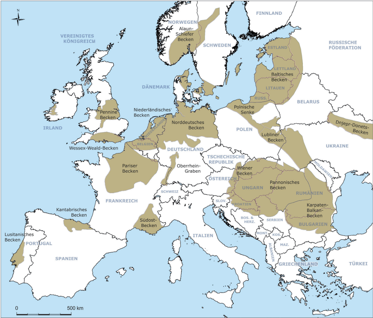
Abb. 13: Schematische Darstellung geologischer Becken mit möglichem Schieferöl- und Schiefergas-Potenzial in Europa.
