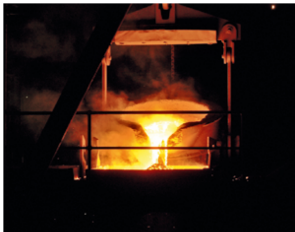
Abb. 2: Ausguss von flüssigem Rohsilizium zum Erkalten in der Hütte der SIMCOA Operations Pty Ltd. in Kemerton/Australien, Foto: BGR.
