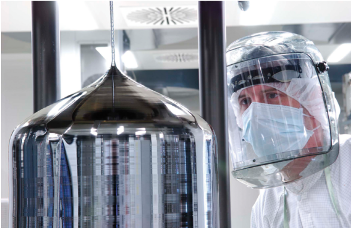
Abb. 19: Anfangskonus eines Einkristalls aus Reinstsilizium mit 300 mm Durchmesser, der an dem Impfkristall in einer Ziehanlage hängt. Im Hintergrund ein Mitarbeiter mit Schutzausrüstung, Foto: SILTRONIC AG (mit frdl. Genehmigung).
