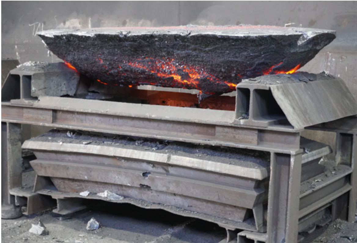
Abb. 9: Erkaltender Siliziumbarren in der Hütte der RW silicium GmbH in Pocking, Foto: BGR.
