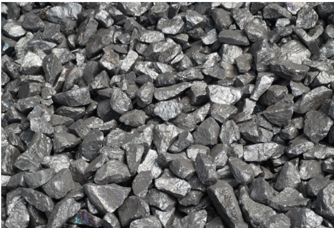
Abb. 10: Gebrochenes Rohsilizium, fertig zum Versand, in der Siliziumhütte der RW silicium GmbH in Pocking, Foto: BGR.
