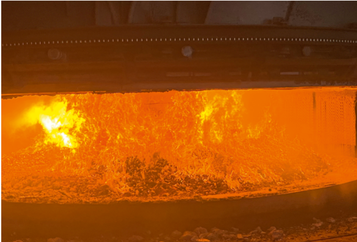
Abb. 6: Ansicht des Zufuhrbereichs eines der Schmelzöfen in der Siliziumhütte der RW silicium GmbH in Pocking, Foto: BGR.
