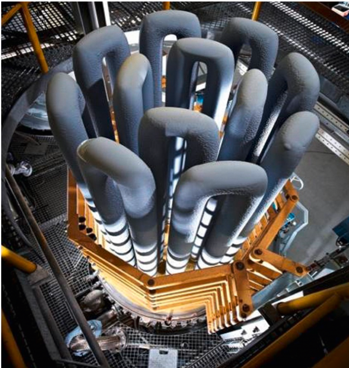
Abb. 15: Die nach dem Siemens-Verfahren gewachsenen Stäbe aus Polysilizium werden sichtbar, nachdem die Stahlkappe des Abscheidereaktors abgehoben wurde, Foto: SILICON PRODUCTS BITTERFELD GMBH & CO. KG (mit frdl. Genehmigung).
