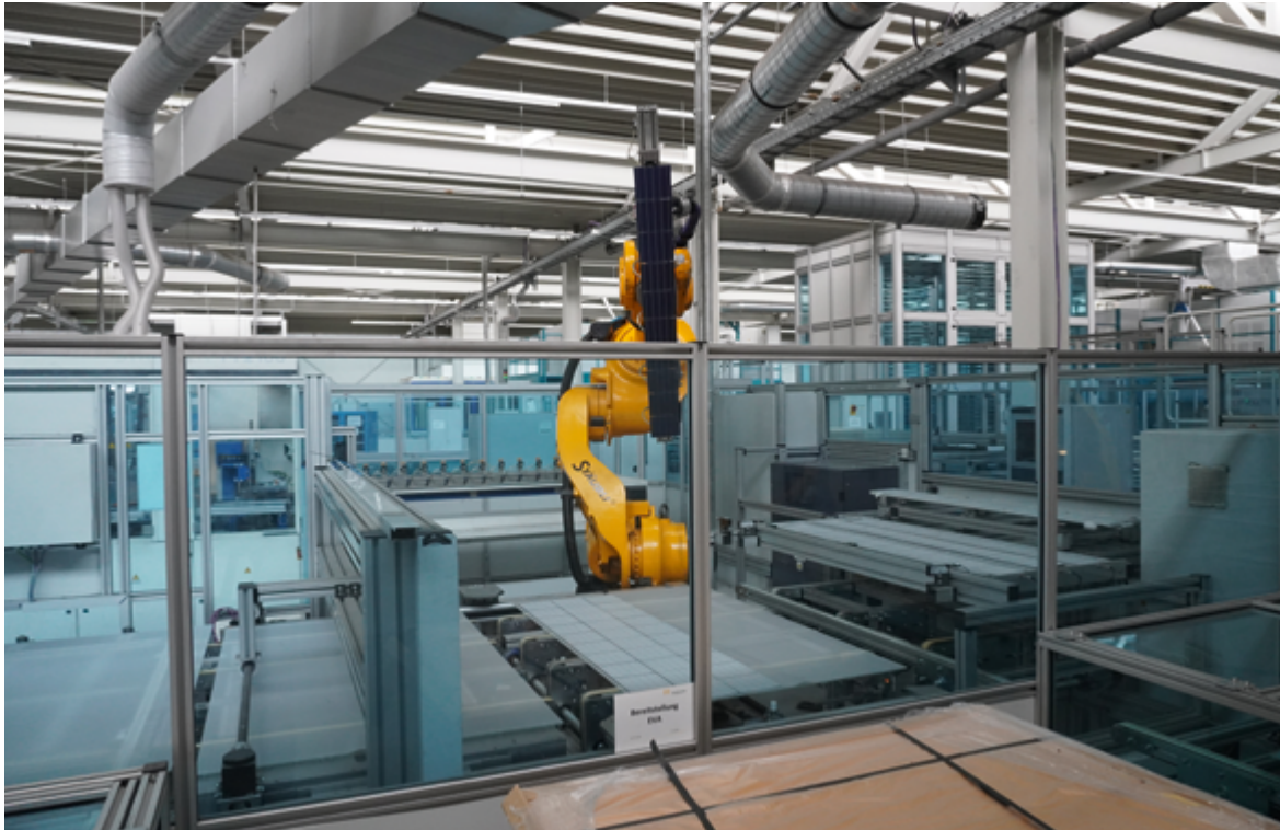
Abb. 21: Montage von Solarzellen zu Solarmodulen im Werk Chemnitz der Heckert Solar GmbH, Foto: BGR.
