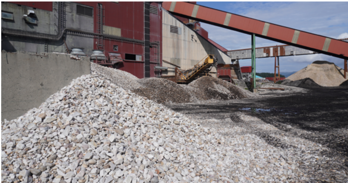
Abb. 52: Gemisch aus Quarzit und Quarzkiesen aus verschiedenen Ländern für die Siliziumproduktion im hochmodernen Werk Holla der Wacker Chemie AG in Norwegen, Foto: BGR.
