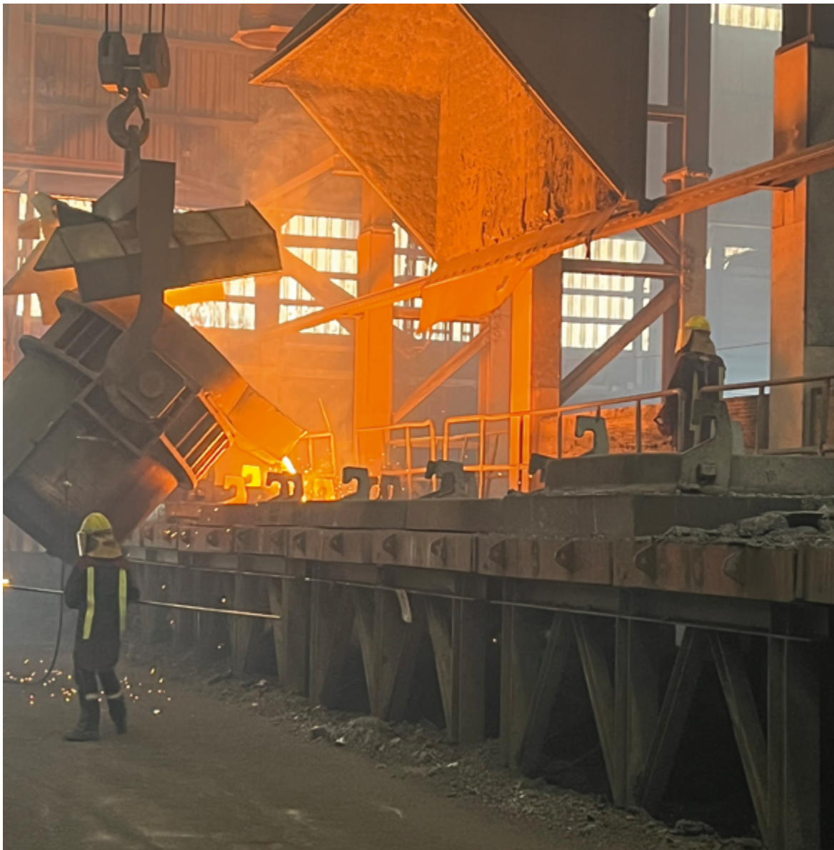
Abb. 8: Ausguss von Tiegeln mit flüssigem Rohsilizium direkt aus dem Schmelzofen der PCC BakkiSilicon hf zum Erkalten, Foto: BGR.
