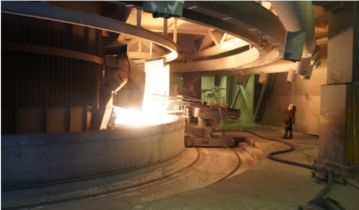
Abb. 53: Abstich von flüssigem Rohsilizium aus dem weltgrößten Siliziumofen (47 MW) im Werk Holla der Wacker Chemie AG, Foto: BGR.
