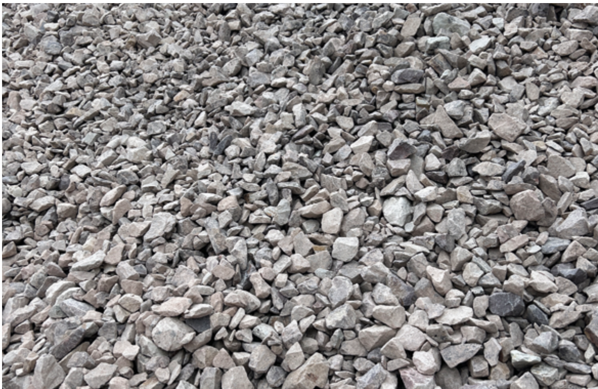
Abb. 23: Quarzit aus Tana in Nordnorwegen, selbst in Si-Qualität 5005, wird aufgrund seines erhöhten Ti-Gehaltes nur in wenigen Hütten zur Siliziumproduktion eingesetzt, Foto: ELKEM ISLAND für BGR. Stattdessen gilt derzeit Quarzit aus Ägypten, gefolgt von Quarzit aus der Türkei als qualitativ hochwertigster in Europa verfügbarer Siliziumrohstoff (ELKEM ISLAND, frdl. mdl. Mitt.).
