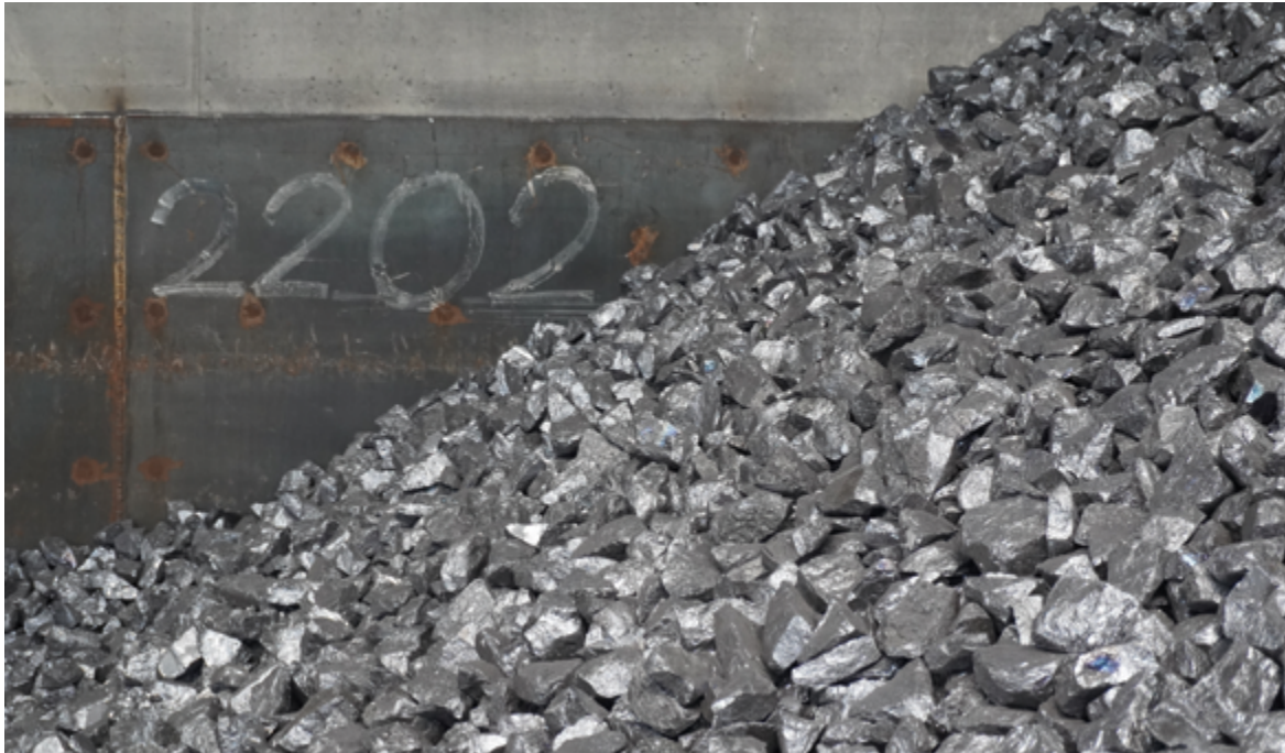
Abb. 26: Die chinesischen Qualitätsbezeichnungen für Silizium haben sich weltweit durchgesetzt wie hier an einer Lagerbox für die Sorte 2202, die in der Produktion von Aluminiumlegierungen Verwendung findet, Foto: BGR.
