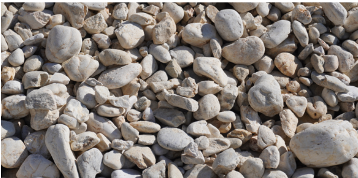
Abb. 25: Quarzkies aus dem benachbarten Österreich ist der bevorzugte Siliziumrohstoff der RW silicium GmbH in ihrer Siliziumhütte im grenznahen Pocking, Foto: BGR.
