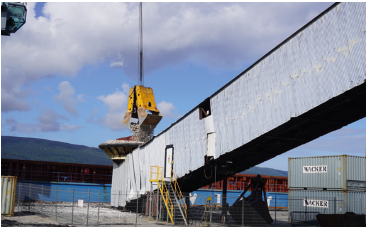
Abb. 24: Entladung von Quarzkies aus Spanien für die Rohsiliziumproduktion im norwegischen Werk Holla der Wacker Chemie AG, Foto: BGR.
