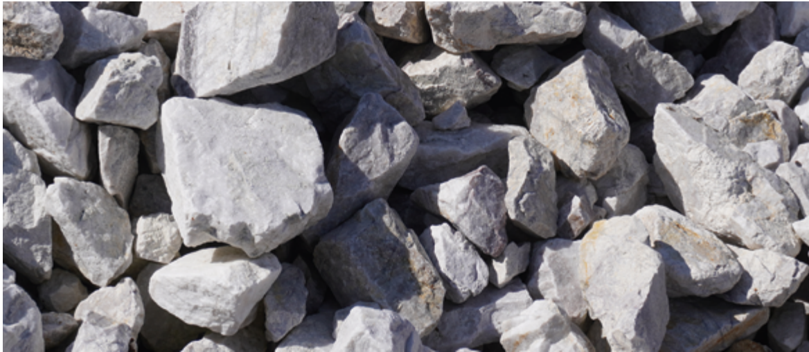
Abb. 3: Gangquarz aus dem Bayerischen Pfahl, hier auf einer Vorratshalde der RW silicium GmbH in Pocking, ist zwar optisch rein, enthält aber häufig zu hohe Al-Gehalte, Foto: BGR.
