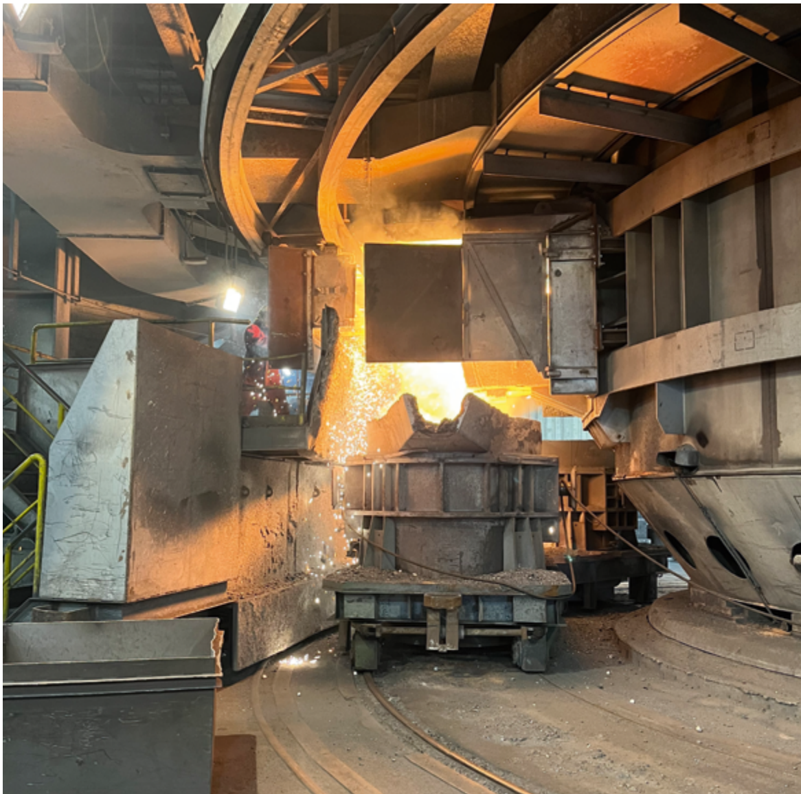
Abb. 1: Abstich von flüssigem Rohsilizium in der Siliziumhütte der PCC BakkiSilicon hf auf Island, Foto: BGR.
