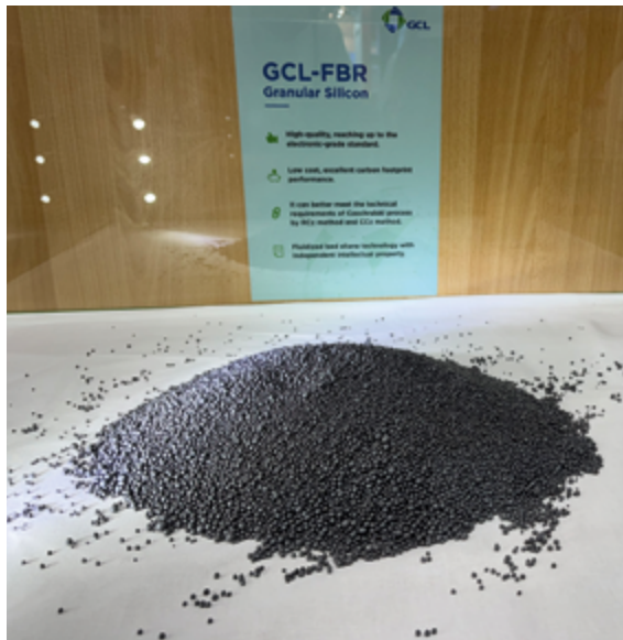
Abb. 17: Körniges bzw. granulares, nach dem FBR-Verfahren produziertes Polysilizium aus einem Werk der GCL Technology Holdings Ltd. in China, Foto: BGR.
