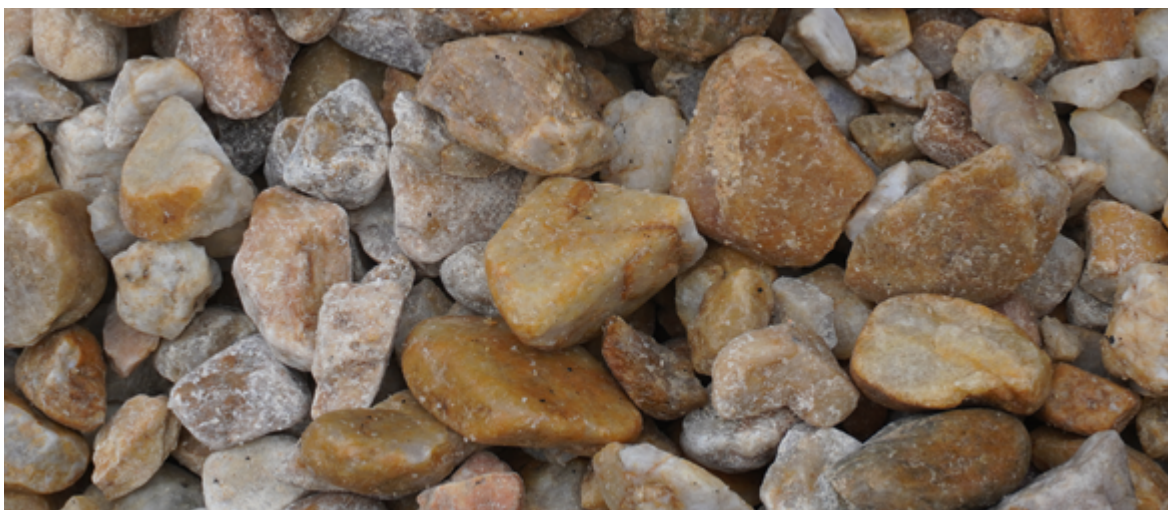
Abb. 4: Quarzkies aus Frankreich sieht zwar optisch nicht sehr rein aus, wird aber wegen seiner geringen Gehalte an Verunreinigungen in verschiedenen europäischen Siliziumhütten, wie hier bei der PCC BakkiSilicon auf Island, sehr gerne als Quarzrohstoff eingesetzt, Foto: BGR.
