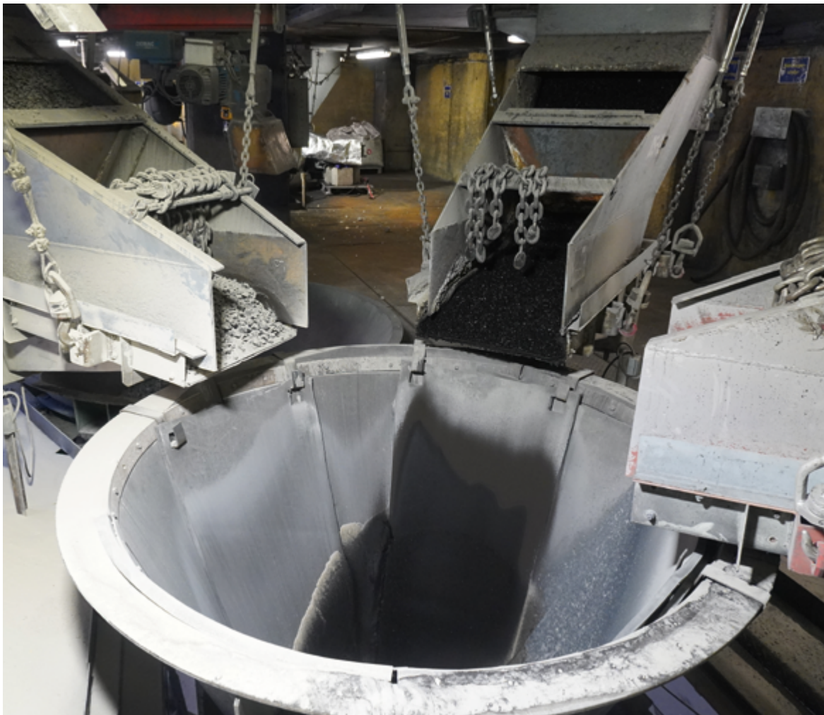
Abb. 5: Rezeptabhängige automatische Zufuhr von Kohle, Quarz und Holzkohle in einen der beiden Schmelzöfen der norwegischen Siliziumhütte Thamshavn der Elkem ASA. Die Holzhackschnitzel werden aufgrund ihres großen Volumens erst später bzw. direkt dem Möller zugeführt, Foto: BGR.
