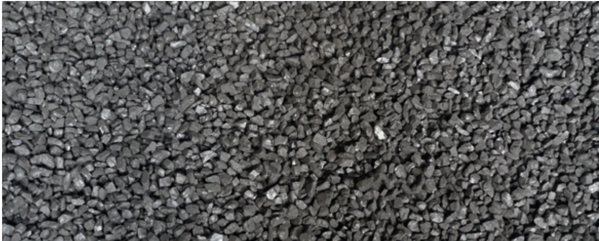
Abb. 12: Gewaschene, aschearme Kohle aus Kolumbien zählt in den europäischen Siliziumhütten derzeit als das am besten geeignete Reduktionsmittel, Foto: BGR.
