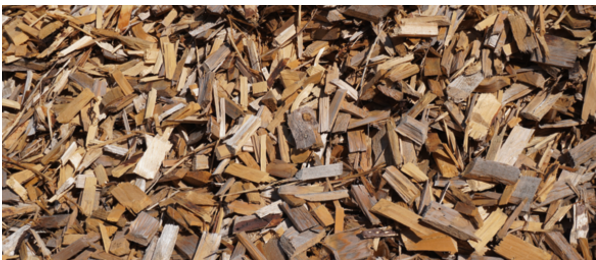
Abb. 14: Der Einsatz von Holz hackschnitzeln ist zur Optimierung der Gasdurchströmung im Möller unverzichtbar, Foto: BGR.
