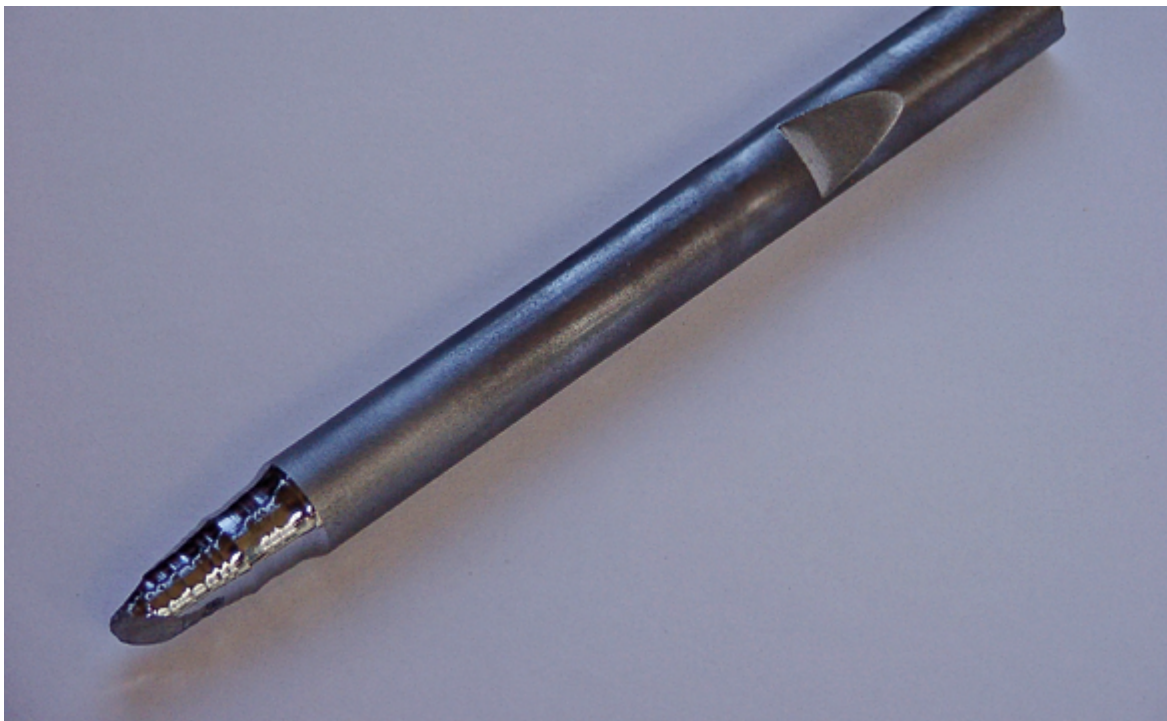
Abb. 18: Monokristalliner Impfkristall aus Reinstsilizium für die Herstellung eines monokristallinen Siliziumeinkristalls nach dem Czochralski-Verfahren. Die glänzende Spitze wird in das aufgeschmolzene Polysilizium eingetaucht und dient als Impfkristall. Am anderen Ende eine Nut zur Befestigung der Ziehvorrichtung. Der gesamte Impfkristall wiegt 30 g, ist ca. 14 cm lang und besitzt einen Durchmesser von 1,2 cm, Foto: WARUT ROONGUTHAI/Wikipedia.
