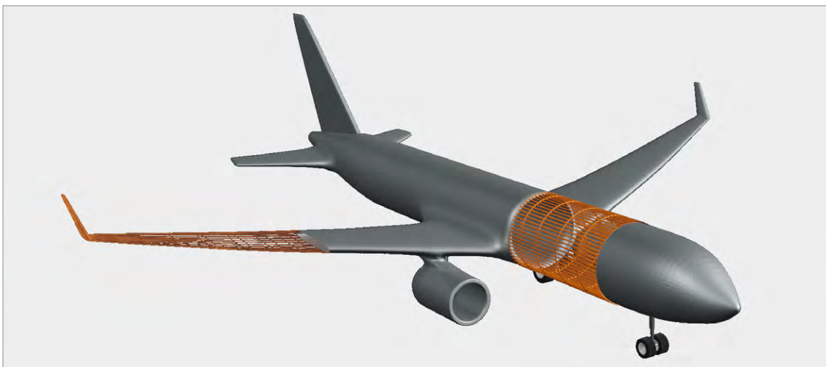
Abb. 3.2: Schematische Darstellung des Airframes eines Passagierflugzeugs, bestehend aus Rumpf, Tragflächen, Triebwerksgondel, Verkleidung, Heck und Fahrgestell (Quelle: mit freundlicher Genehmigung von E. Tercero Daschner)
