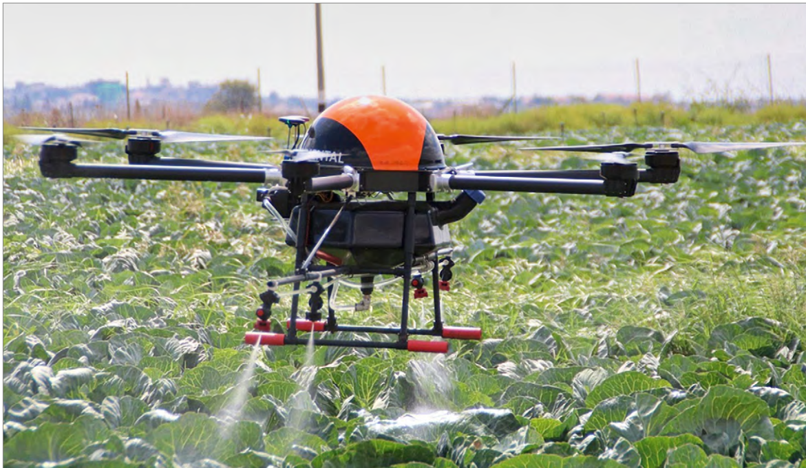
Abb. 3.9: Unbemanntes 3D-Luftfahrzeug zum Ausbringen von Pflanzenschutzmittel (Quelle: https://commons.wikimedia.org/wiki/File:4X-UHJ_Agridrones_d.jpg ; Lizenz: CC BY-SA 4.0)
