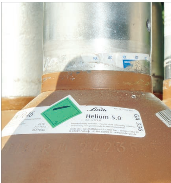
Abb. 20: Helium wird heute fast nur noch in der Standardqualität 5.0 (99,999 % He) angeboten, Foto: BGR.
