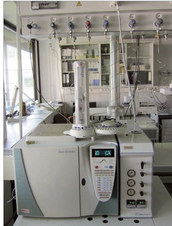
Abb. 47: Gaschromatograph im Arbeitsbereich „Geochemie der Energierohstoffe und Gasmonitoring“ der BGR mit verschiedenen Gasanschlüssen oberhalb des Geräts, Foto: BGR.
