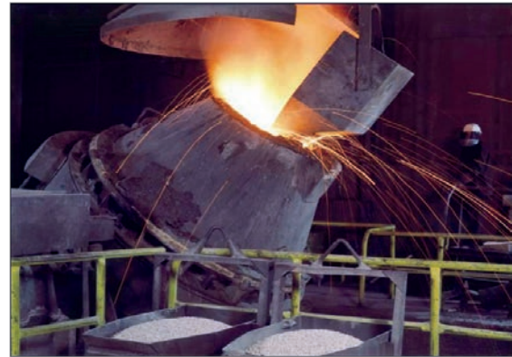
Abb. 16: Herstellung einer CrMoWVNbN-Edelstahlegierung in einem Konverter mittels Argon-Sauerstoff-Entkohlungsverfahren, Foto: Goodwin Steel Castings/Wikipedia.
