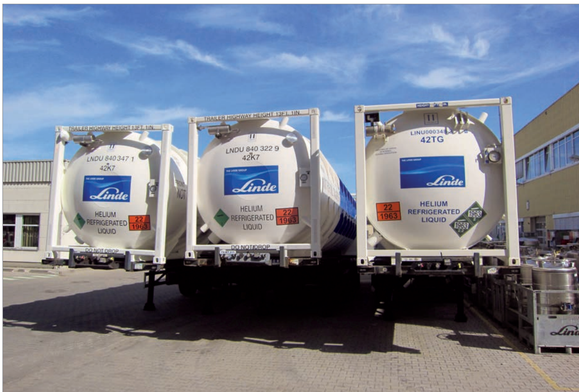
Abb. 27: ISO-Kühlcontainer zum Transport von flüssigem Helium im Werk Unterschleißheim der Linde AG. Die zwei Container links wurden von Linde Engineering, der Container rechts von Gardner Cryogenics, Inc., gefertigt, Foto: BGR.
