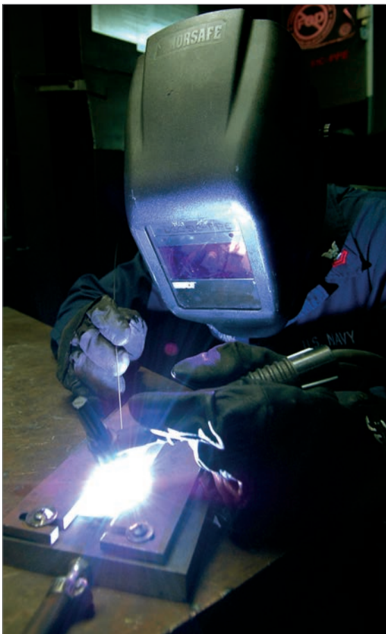
Abb. 9: Wolfram-Inertgas-Schweißen in einer Schutzgasatmosphäre aus Argon oder Helium eignet sich zum Schweißen von allen Metallen und Legierungen, bei denen Qualität wichtiger ist als Schweißgeschwindigkeit, Foto: US Navy/Wikipedia.
