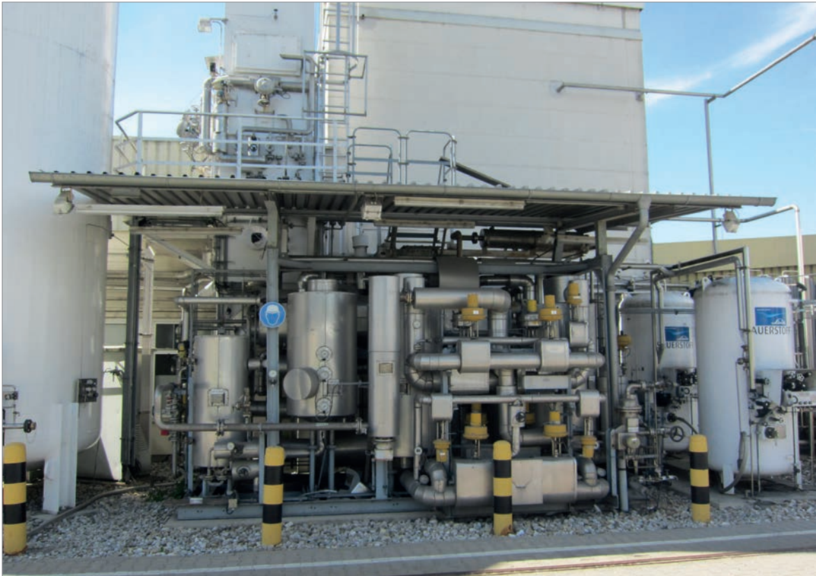
Abb. 52: Blick auf einen Teil der Aufreinigungsanlage für Rohkrypton und Rohxenon im Werk Unterschleißheim der Linde AG, Foto: BGR.
