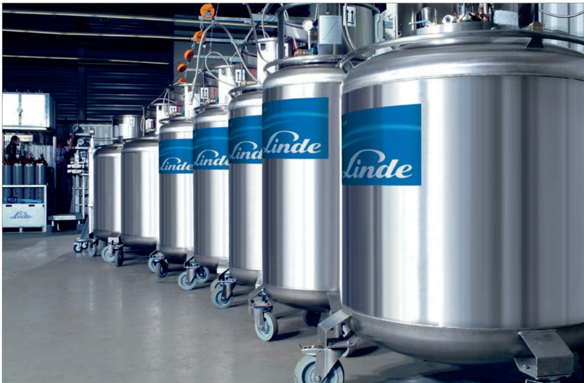
Abb. 29: Mit 450 l flüssigem Helium gefüllte Transportbehälter im Werk Unterschleißheim der Linde AG, Foto: Linde AG (mit frdl. Genehmigung).
