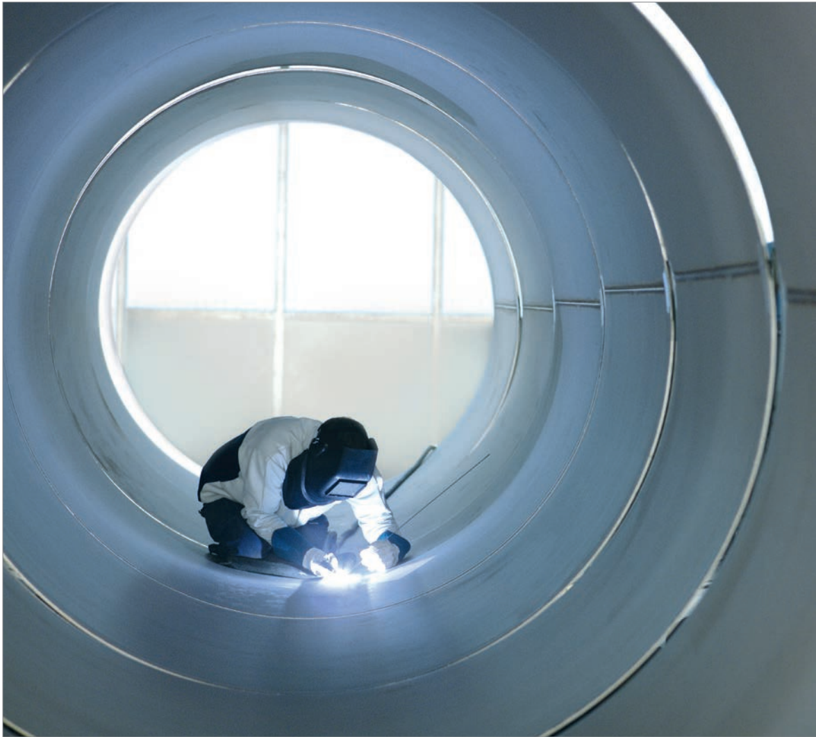
Abb. 15: Schweißen von Edelstahl nach dem Wolfram-Inertgas-Schweißen geschieht meist in einer Schutzgasatmosphäre aus Argon oder seltener Helium, Foto: Linde AG (mit frdl. Genehmigung).
