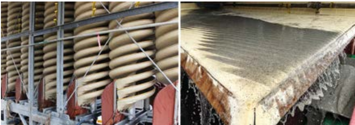
Abb. 3: Schwerentrennung über Wendelscheider (links) und Rütteltische (rechts) (BGR 2017).
