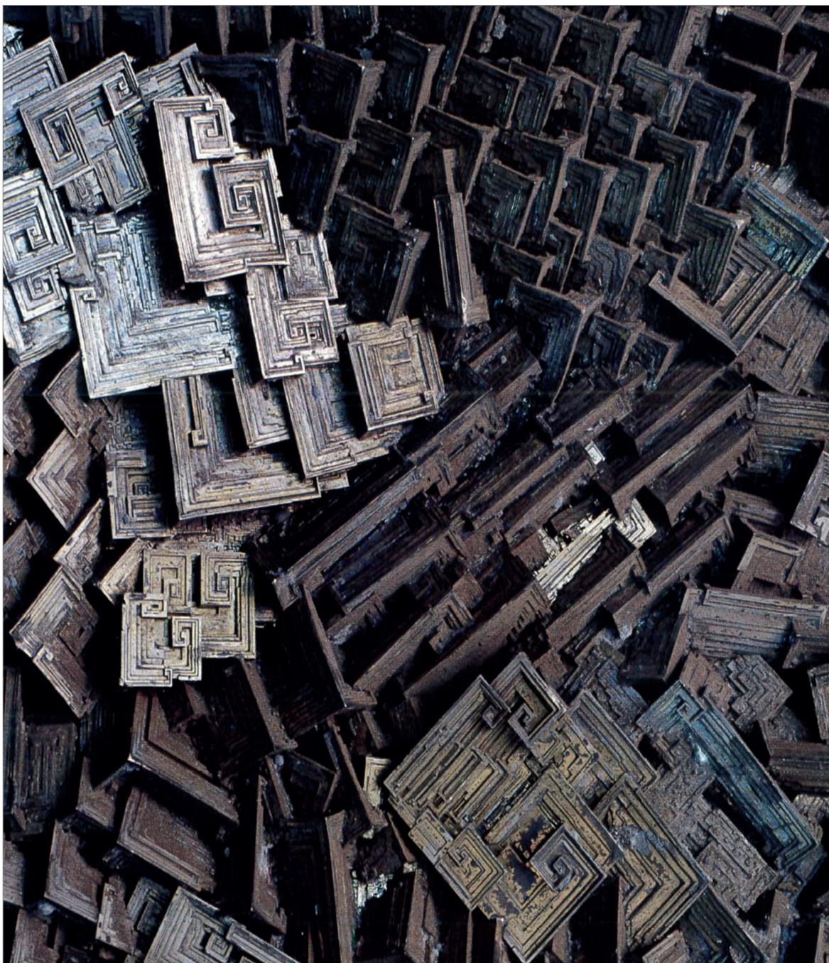
Abbildung 1: Typische Bismutkristalle aus der Bismutschmelze, Foto: Aurubis AG (Wiedergabe mit frdl. Genehmigung).
