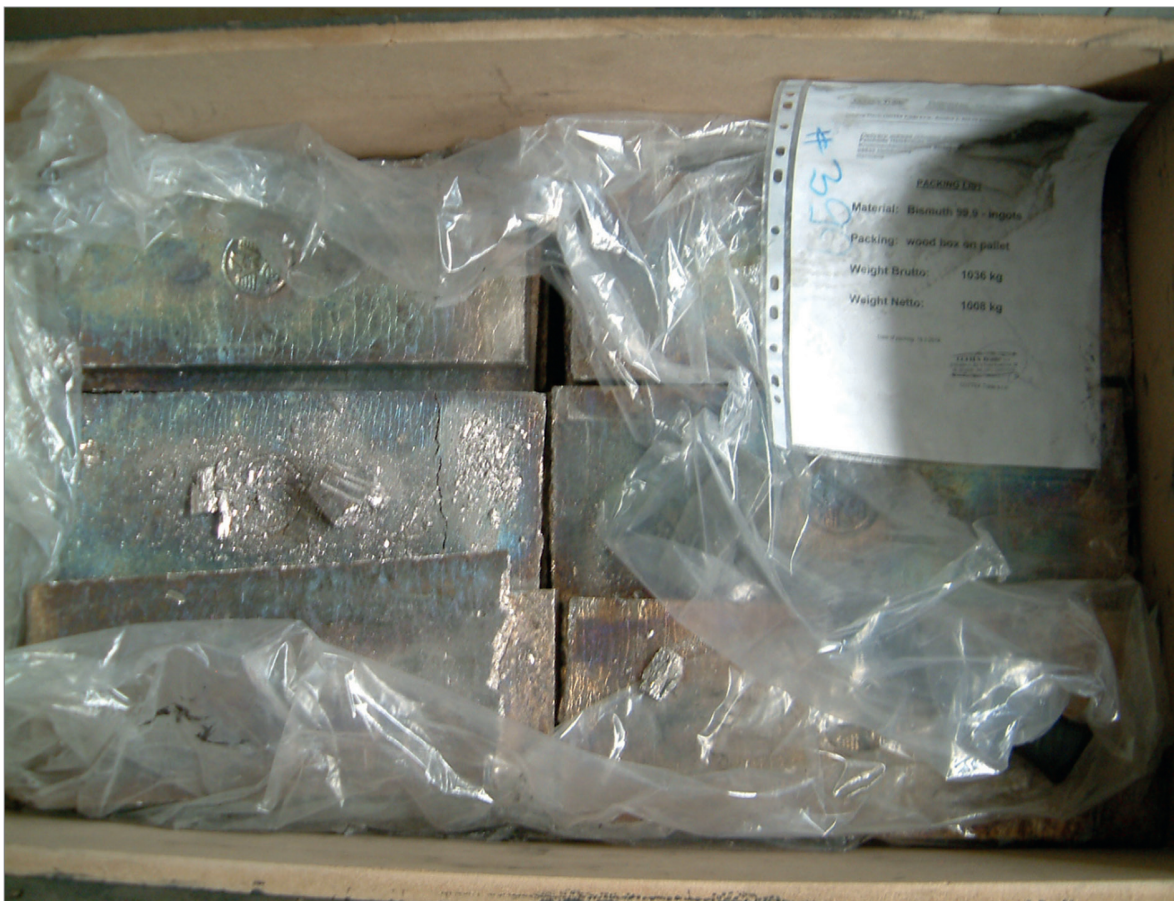
Abbildung 7: Bismutbarren @ 99,9 % Bi zur Herstellung von Weichloten, Foto: BGR.
