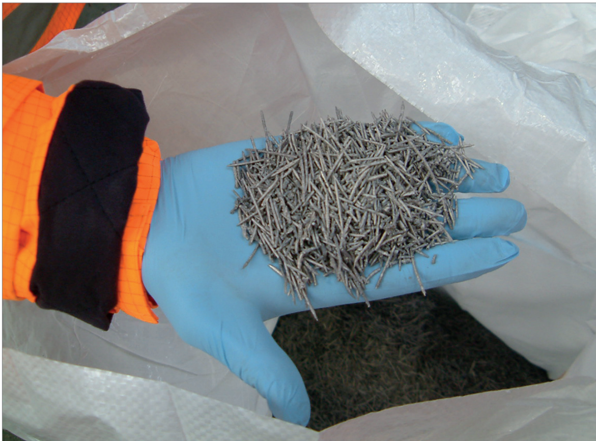
Abbildung 16: Bismut in Nadelform aus der Produktion von 5N Plus in Tilly, Belgien, Foto: BGR.
