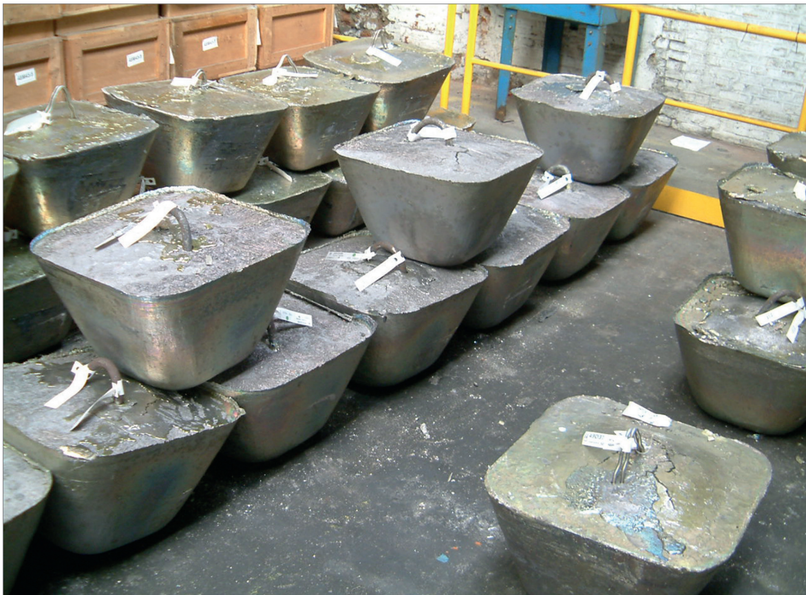
Abbildung 24: Raffinadebismut aus eigener Produktion bei der 5N Plus in Tilly, Foto: BGR.
