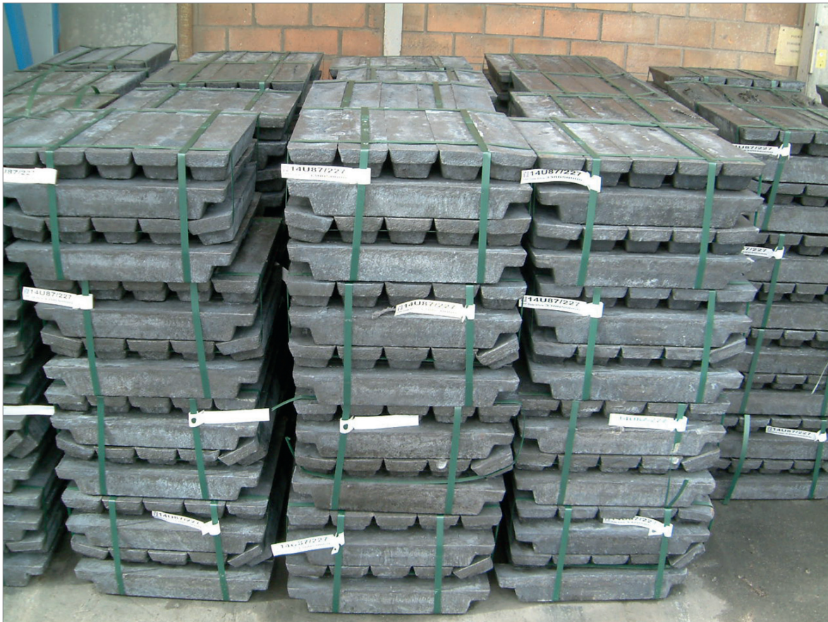
Abbildung 4: Blei-Bismut-Barren als Ausgangsprodukt der Raffinadebismutproduktion bei der Firma 5N Plus in Tilly, Belgien (Foto: BGR).
