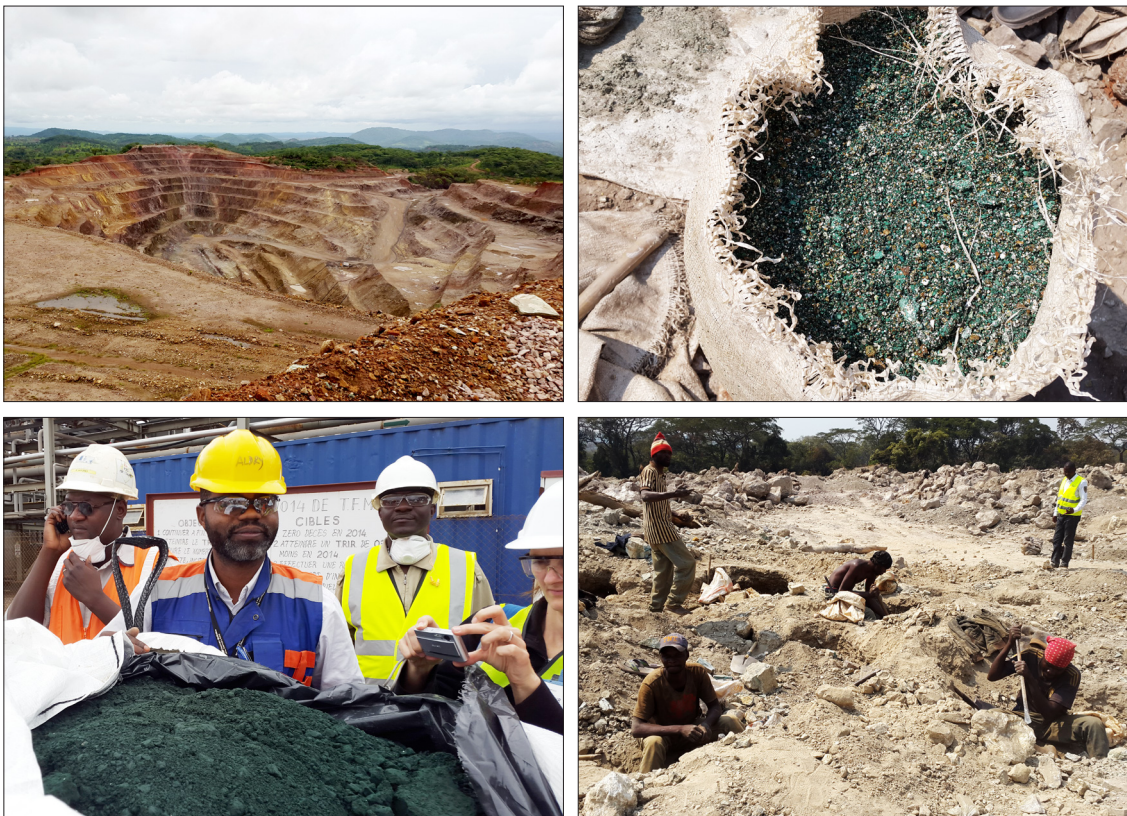
Figure 7: Site d'exploitation minière de cuivre et de cobalt, industrielle (à gauche) et artisanale (à droite) en République Démocratique du Congo avec leurs produits respectifs : hydroxyde de cobalt et concentré de cobalt-cuivre. L'exploitation industrielle présentée correspond à l'open-pit de Kwatebala à Tenke Fungurume, Province du Haut Katanga. L'exploitation artisanale a lieu dans la mine de Kamwale, Province de Lualaba (F: BGR).
