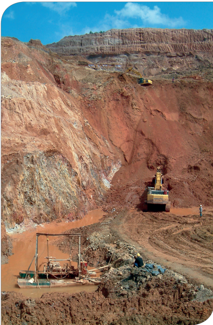
Abb. 5: Abraumgewinnung durch einen Subkontraktor von PT Timah zur Freilegung einer Cassiteritgangerzlagertstätte (links im Bild) im Nordwesten von Bangka Island. In der nahe gelegenen Aufbereitungsanlage wird ein Zinnsteinkonzentrat mit durchschnittlich 53 % Sn-Gehalt produziert, das dann in der Hauptzinnhütte von PT Timah in Mentok verhüttet wird.
