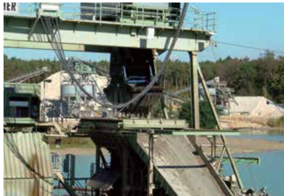
Auch in Raunheim fördert ein Schwimmgreifer Sande für die Industriesandproduktion im angeschlossenen Quarzsandwerk, Foto: BGR.
