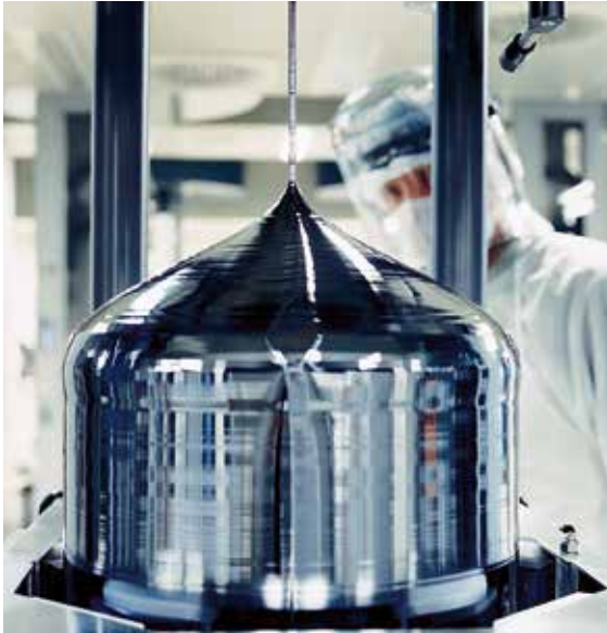
Reinstsiliziumstab, aus dem Reinstsiliziumscheiden für Halbleiter- und Mikroelektronikanwendungen gesägt werden, Foto: Wacker Chemie AG (mit frdl. Genehmigung).
