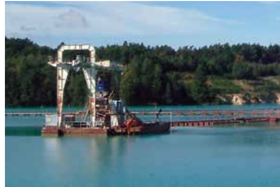
Gewinnung hochwertiger Quarzkiessande mittels Schwimmgreifer bei der Quarzwerke Witterschlick GmbH, Foto: BGR.
