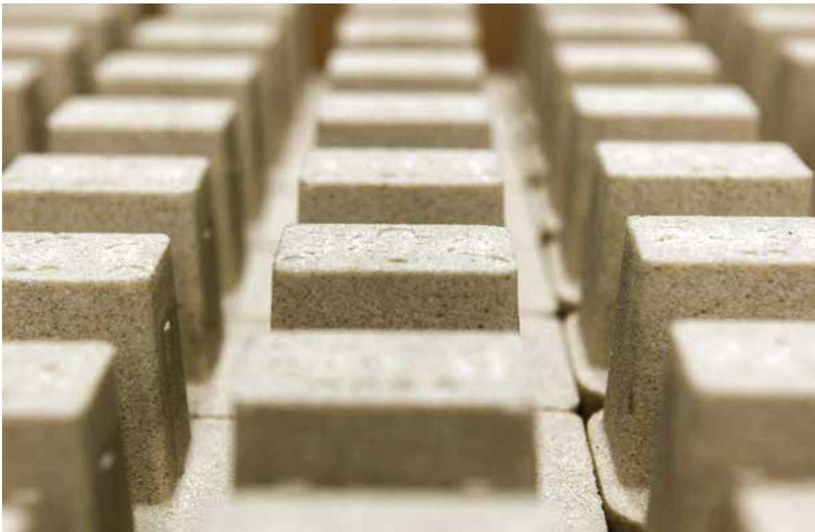
Chemisch oder mit Ton gebundene Gießform- und Kernteile auf Quarzsandbasis finden Einsatz in der Fertigung kleinerer Gussteile, Foto: Andreas Bednareck (mit frdl. Genehmigung).
