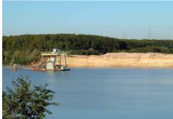
Die Kaspar Weiss GmbH & Co. KG gewinnt mittels Schwimmgreifer am Stadtrand von Rodgau quarzreiche Kiessande eines früheren Mains, Foto: BGR.
