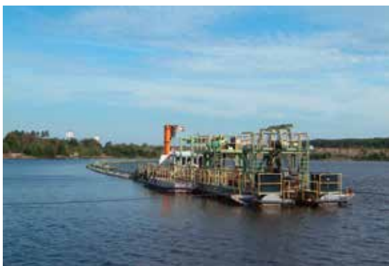
Saugbaggerschiff „Maike“ im Einsatz im Quarzsandwerk Hohenbocka der Quarzwerke GmbH, Foto: BGR.
