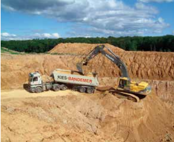
Abbau von über 30 Millionen Jahre alten Quarzkies-sandschichten bei Dodenburg in der Eifel, Foto: BGR.
