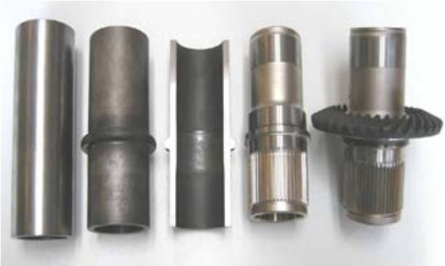
Einzelne Stufen vom Roh(r)material bis zum fertigen Bauteil
