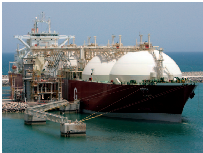
Verschiffung von LNG in Druckcontainern
