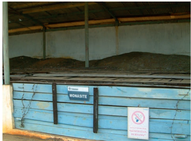
Abb. 11: Monazitkonzentratlager von PT Timah. Hinweise auf eine mögliche Strahlenbelastung fehlen, allerdings wird vor der Schädlichkeit des Rauchens gewarnt, Foto BGR.
