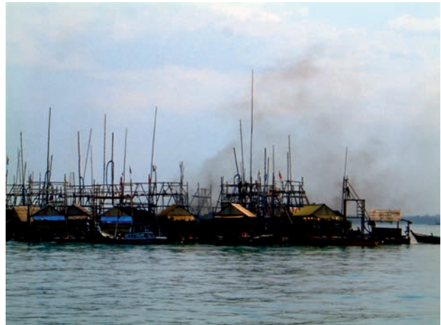
Abb. 10: Cluster von auf Fischerbooten installierten Saugpumpen vor der Küste von Bangka, Foto: BGR.
