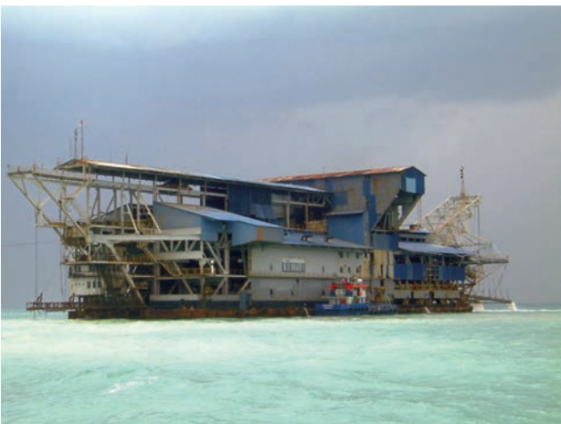
Abb. 9: Schwimmender Eimerkettenbagger vor der Küste von Bangka. Foto: BGR.
