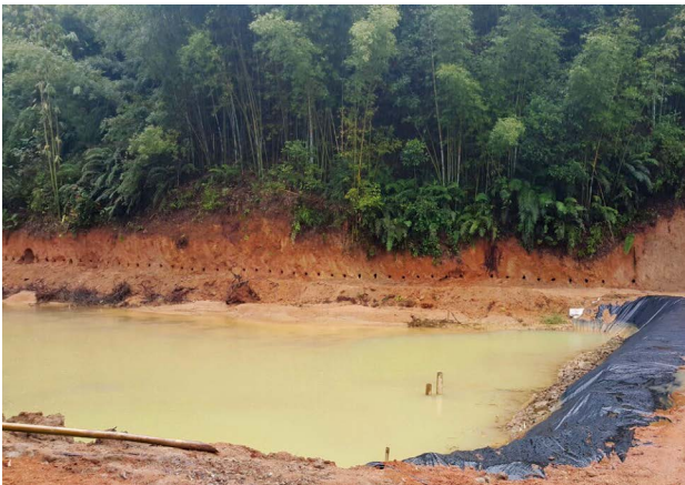
Abb. 8: Auffangbecken der In-situ-Laugung von Ionenadsorptionstonen in Südchina ([20]; Foto von Alain Rollat, mit freundlicher Genehmigung).
