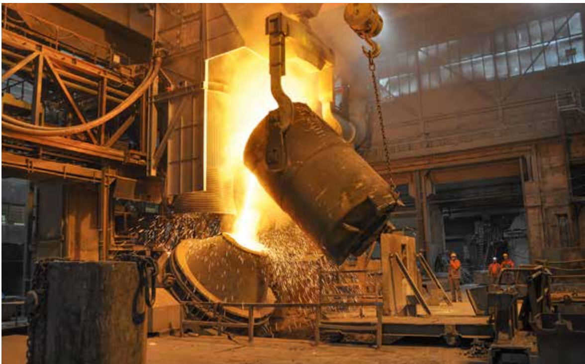
Abb. 10: Einfüllen der Vorschmelze in den AOD („argon-oxygen-decarburization“) -Konverter (Wiedergabe mit freundlicher Genehmigung der BGH Edelstahlwerke GmbH).
