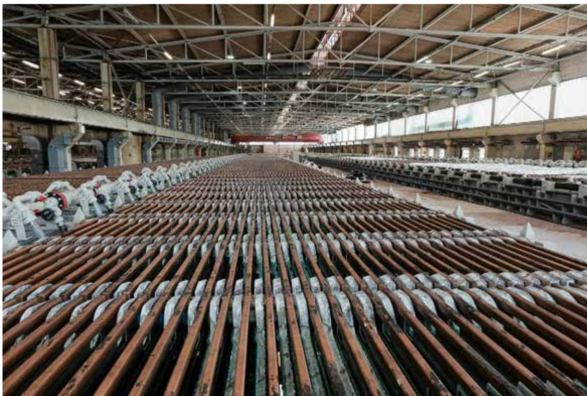
Abb. 26: Kupferraffinationselektrolyse in Lünen. Rohnickelsulfat wird bei der Aufbereitung des Elektrolyten gewonnen (Wiedergabe mit freundlicher Genehmigung der AURUBIS AG).
