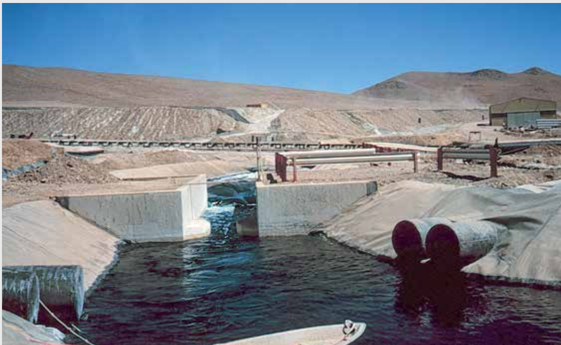
Haldenbiolaugung zur Kupfergewinnung in Chile (aus HEDRICH & SCHIPPERS 2017).
