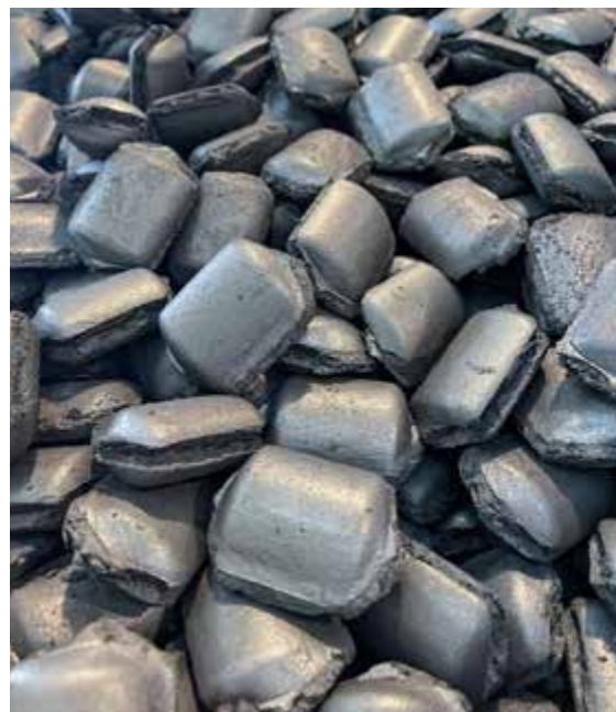
Abb. 24: Briketts der CRONIMET Envirotec GmbH aus dem Recycling von Bohr-, Metall- und Industrieschlämmen sowie Metallstäuben und -pulvern (Wiedergabe mit freundlicher Genehmigung der CRONIMET Envirotec GmbH).
