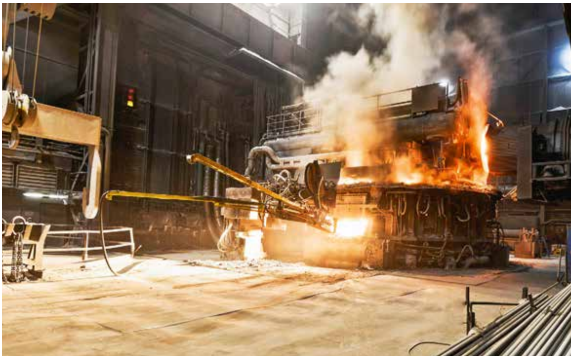
Abb. 11: Edelstahlproduktion im Elektrolichtbogenofen (Wiedergabe mit freundlicher Genehmigung der Deutsche Edelstahlwerke Services GmbH).
