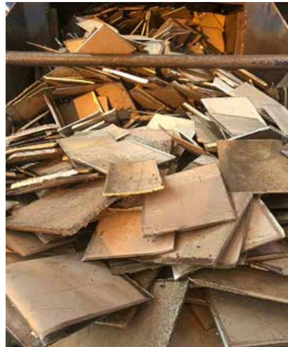
Abb. 12: Geschnittene Nickelkathode als Vorstoff für die Herstellung von Nickellegierungen (Wiedergabe mit freundlicher Genehmigung der Schmidt + Clemens GmbH + Co. KG).
